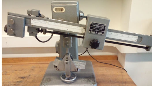
Figuur 3.14: Driepuntsbuigproef ter bepaling van de buigsterkte.
