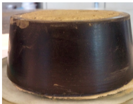
Figuur 5.30: Expansie van 30% BFA14 A&S met 5% \text{Na}_2\text{CO}_3 na 1 dag.
