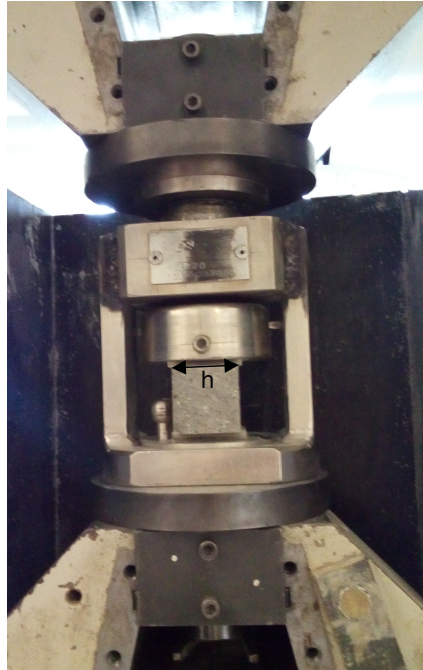
Figuur 3.15: Testapparaat met belastingsoppervlakken voor de druksterkte van mortel.
