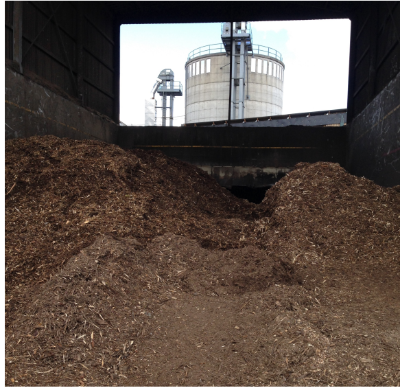
Figuur 3.4: A-hout als biomassabron van ERDA.
