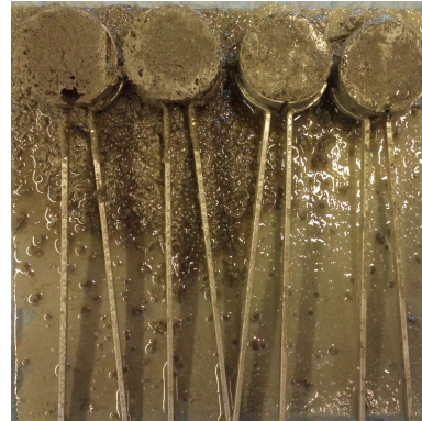
Figuur 5.22: Stabiliteitsproef op 30% gewassen BFA14-W A&S (links) en BFA14-E A&S (rechts).
