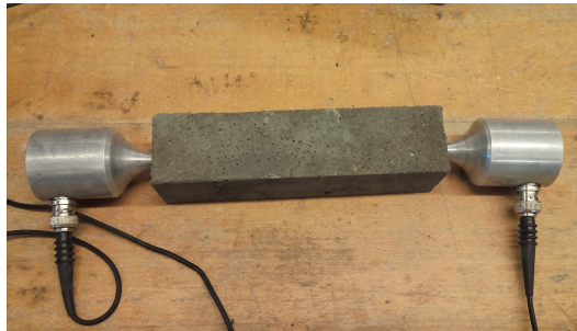
Figuur 3.13: Meetsensoren voor de bepaling van de transmissietijd van geluidsgolven.
