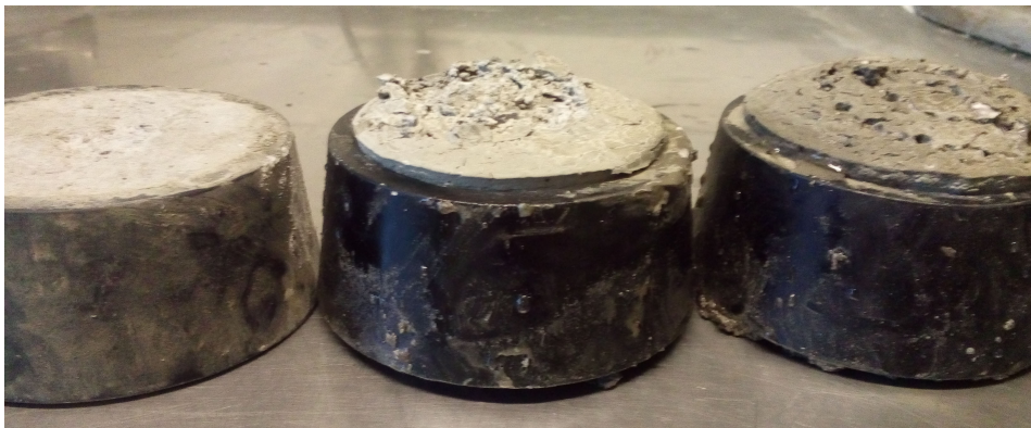
Figuur 5.23: Expansie van cement, 15% BFA12 A&S en 30% BFA12 A&S na 1 dag.
