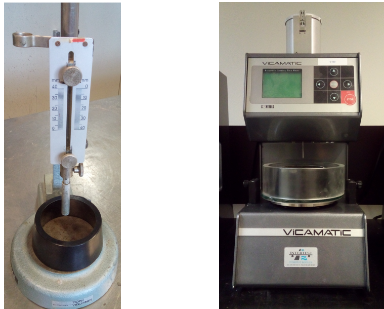
(a) Bepaling van de normaalconsistentie. (b) Bepaling van de bindingstijd.
