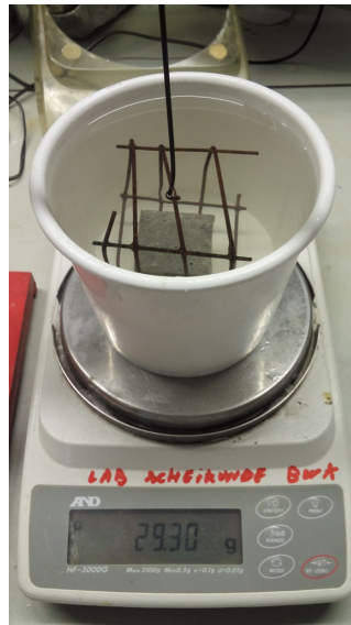
Figuur 3.16: Hydrostatische weging van een monster.
