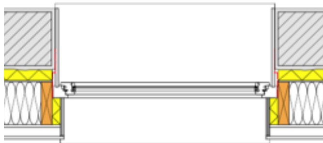
Figuur 3.20 Aansluiting raam aan bestaande structuur
