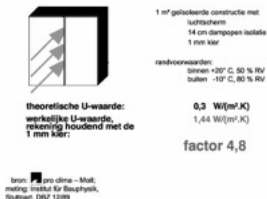
Figuur 3.4 U-waarde ten gevolge van 1mm kier
