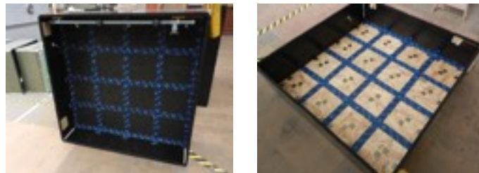
Figuur 2.13 Tape C op houtvezelplaat en OSB
