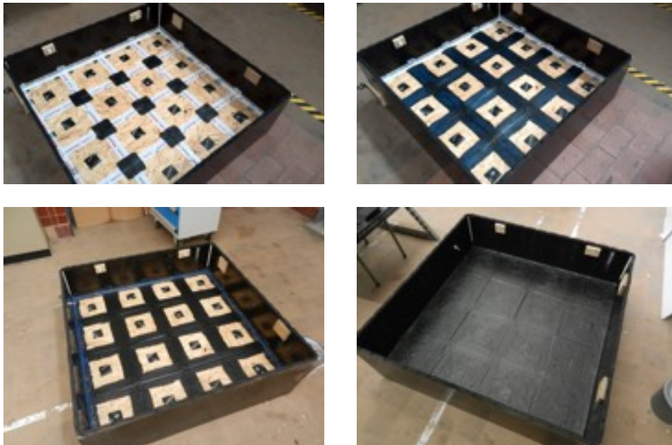
Figuur 2.9 Kruispunten, voegen, zijkanten en volledige oppervlak bedekt
