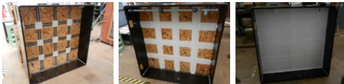
Figuur 2.20 Kruispunten, voegen en volledig oppervlak bedekt
