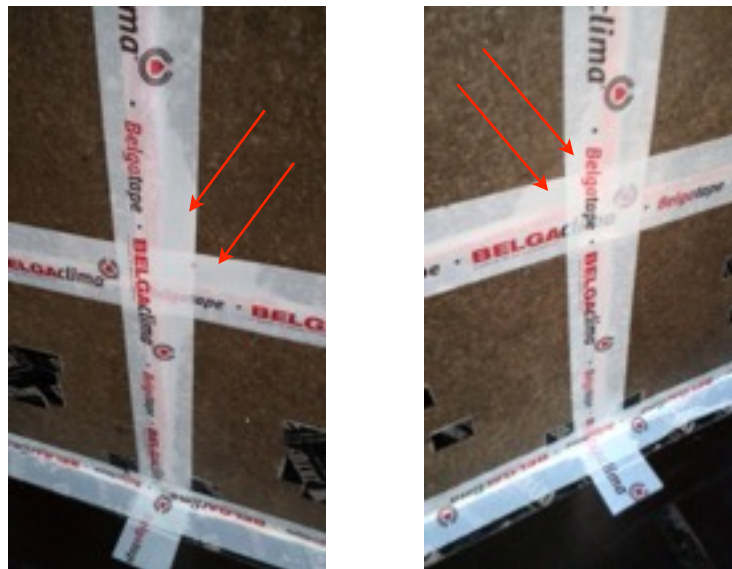
Figuur 2.8 Loskomen van tape A op gebitumineerde houtvezelplaat
