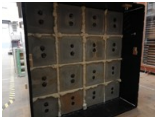
Figuur 2.24 Polyurethaanschuim op betonondergrond
