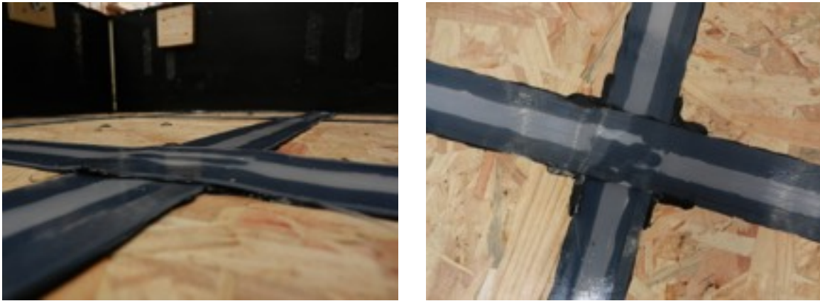
Figuur 2.19 Links: Verminderde hechting silicone ter hoogte van kruispunten, rechts: extra silicone
