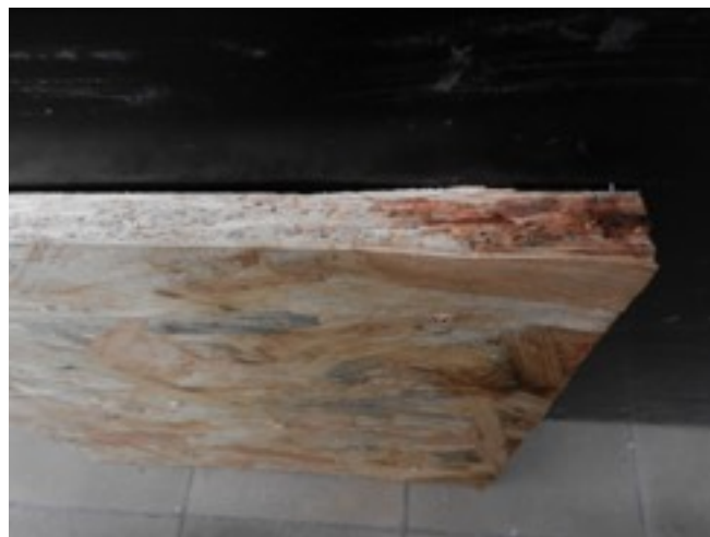
Figuur 2.27 Zwellen van de OSB ten gevolge van blootstelling aan water
