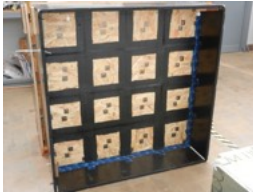
Figuur 2.4 Voegen bedekt met luchtdichte coating
