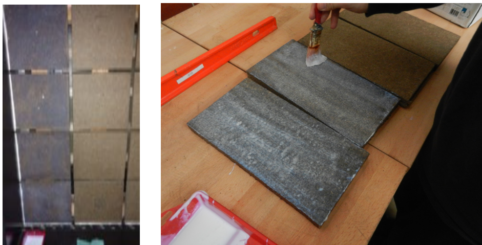
Figuur 1.10 Behandeling houtvezelplaat met primer
