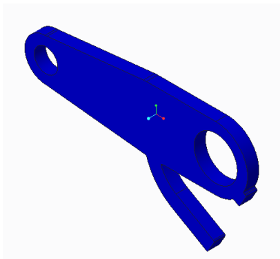
Figuur 130: Arm voor cilinder, ons ontwerp
