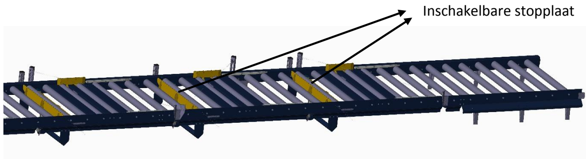
Figuur 31: Rollenbaan met meerdere inschakelbare stopplaten
