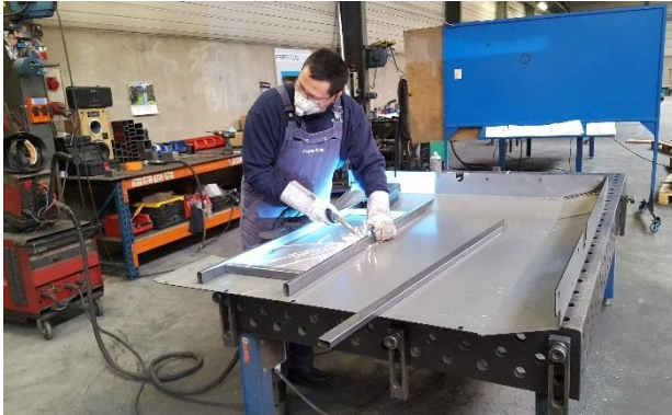
Figuur 163: Lassen van dwarsliggers in zijwand
