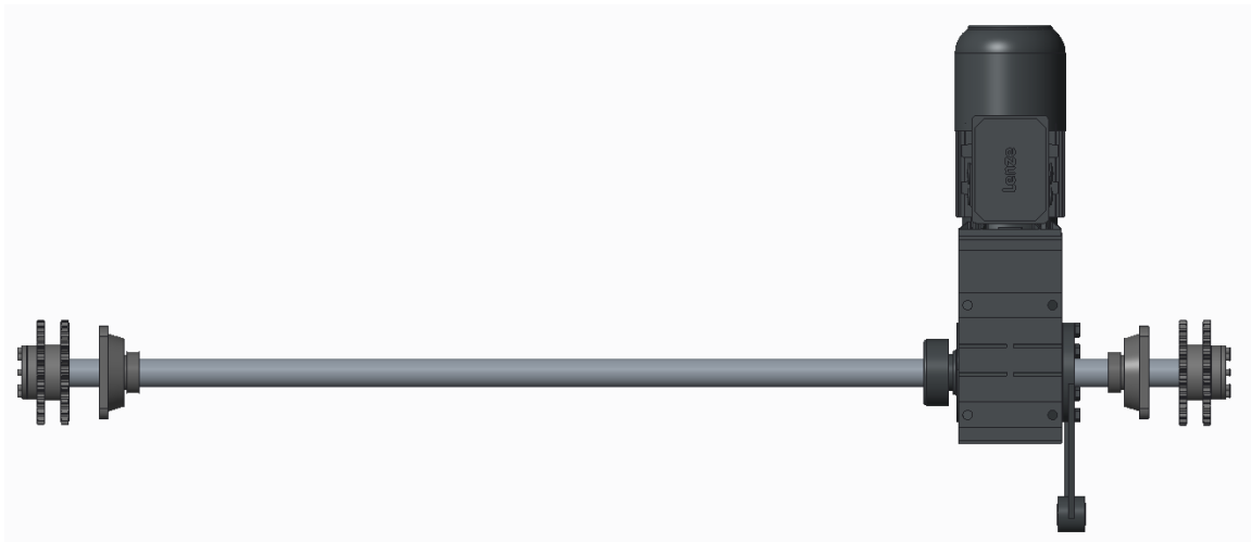
Figuur 104: Aandrijfjas met motor en lagers
