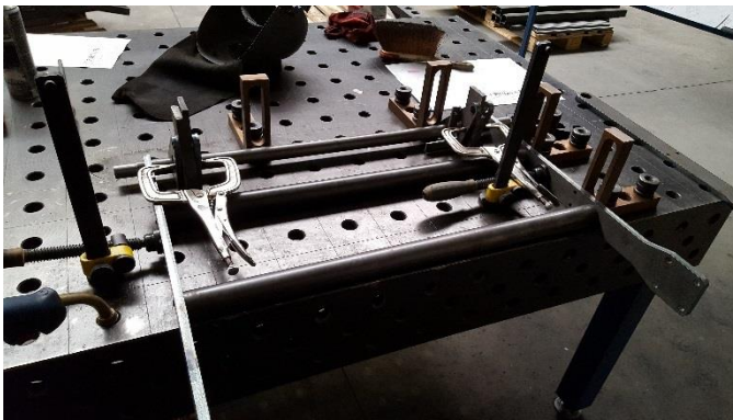
Figuur 170: Opspannen van de onderdelen
