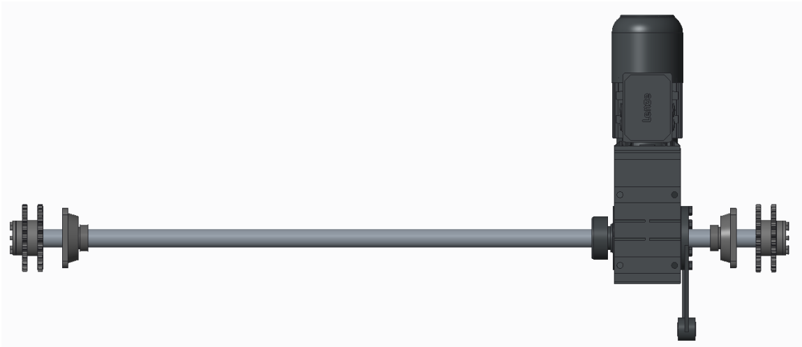
Figuur 91: Aandrijfjas met motor en lagers
