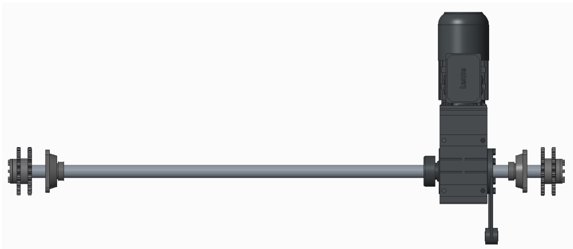
Figuur 101: Aandrijfas met motor en lagers
