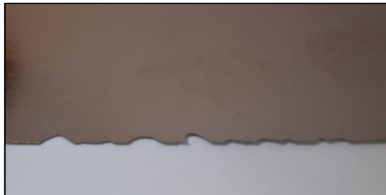
Figuur 29: Plaatschaar gesneden uitgegloeid amorf materiaal met een gloeibehandeling op 350 °C gedurende 2 uur.
