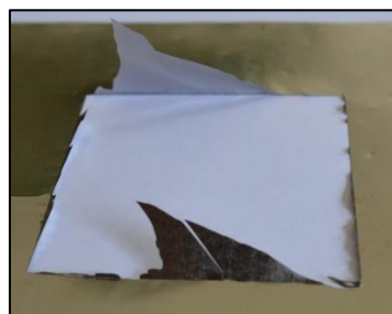
Figuur 27: Geponst uitgegloeid amorf materiaal met een gloeibehandeling op 350 °C gedurende 2 uur.
