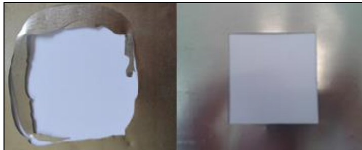
Figuur 26: Niet uitgegloeid amorf materiaal, links: niet correct geponst, rechts: correct geponst.
