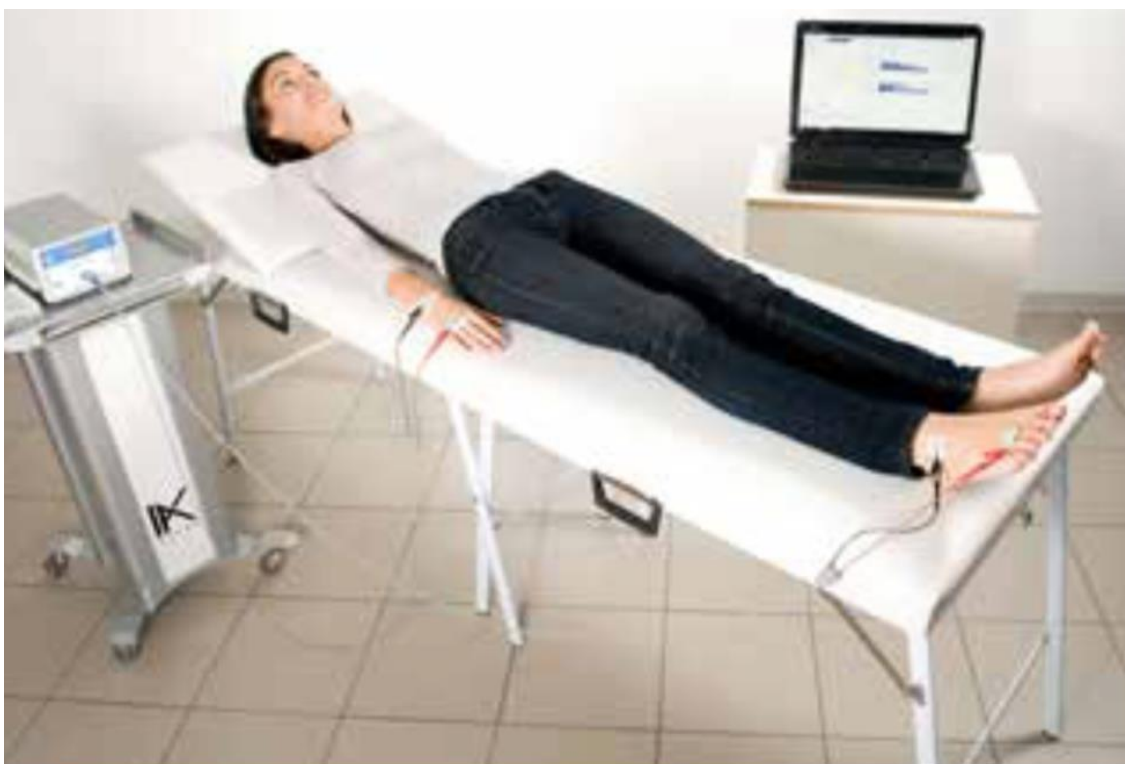
Figuur 4. De vier electrodes van de BIA 101 new edition. Herdrukt van Akern a steap ahead in Body composition, afkomstig van http://www.akern.com/images/DP_101_NE_ENG_Rev0.pdf
