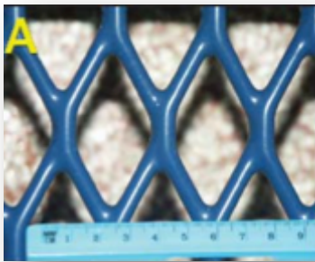
Figuur 6: Diamantvormig PVV-gecoate roostervloer (Kovacs et al., 2005)
