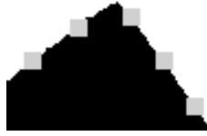
Figuur 3.9: Voorbeeld van een willekeurige polygonale benadering van een rechte hoek
