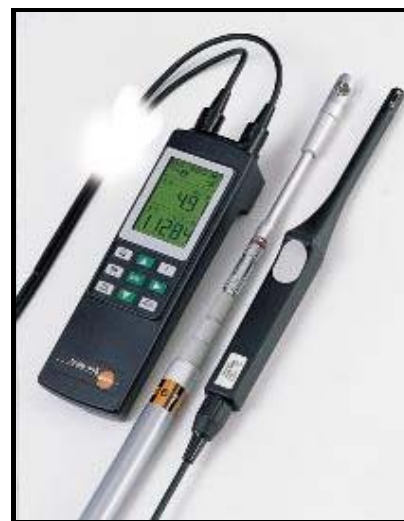
Figuur 3.5 Het klimaatmeetapparaat met vleugelradsonde en temperatuur- en vochtigheidsvoeler
