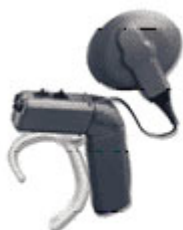
Uitwendige spraakprocessor (oorhanger) Tempo+ BTE van Med-el
