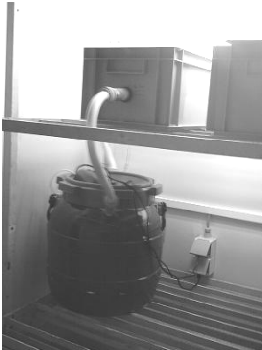
figuur 17: Schema en foto van het hydrocultuursysteem, de vloeistof stroomt in wijzerzin
