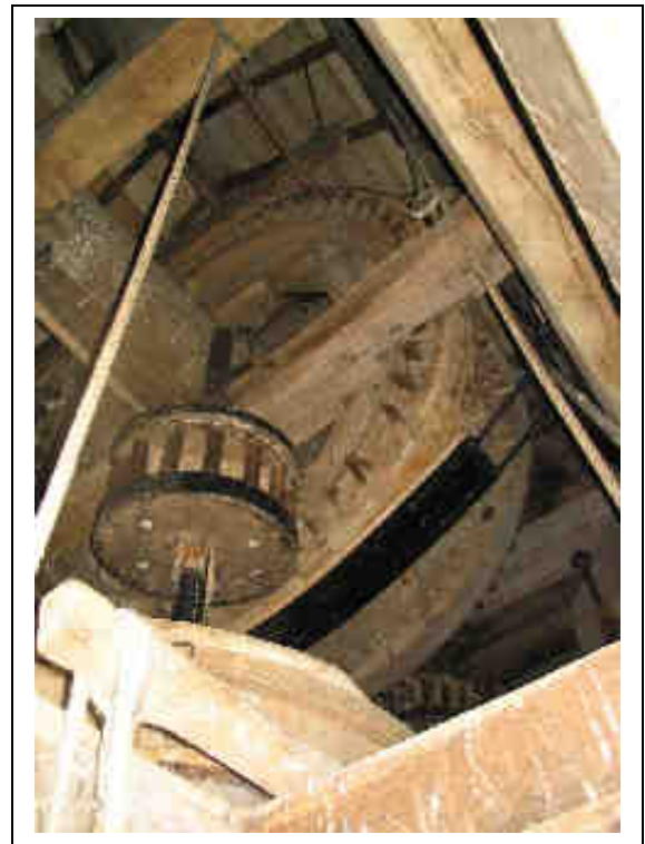
Figuur 86: Vangwiel met ontbrekende kam
