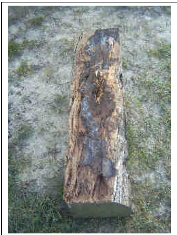
Figuur 64: Rot aan de onderkant van een teerlingblok
