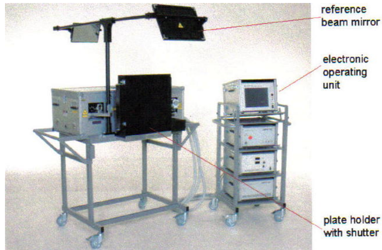
Figuur 36: De mobiele holografische camera
