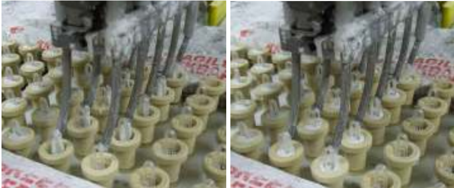
Foto 4: Vullen van de keramische huls
