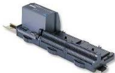
Foto 51: Netwerk terminal en 2 terminal bases
