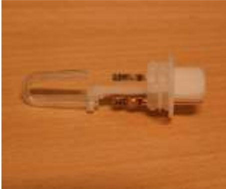
Foto 2: Connector met kwartsbuis en platinadraad
