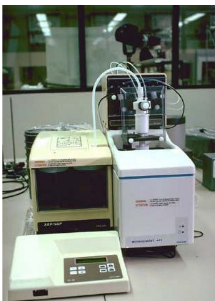
Figuur 10: Micro Digest (rechts) Aspivap 1P (links) en Elektronische eenheid (vooraan)
