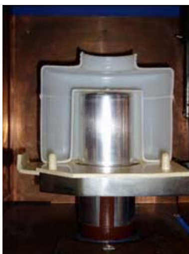
Figuur 17: Doorsnede van een Marinelli over de detector geplaatst
