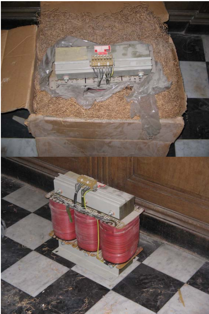
Figuur 3.48: Transformator drie fasig
