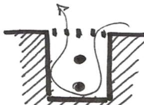
Figuur 73 : principe vloerconvector
