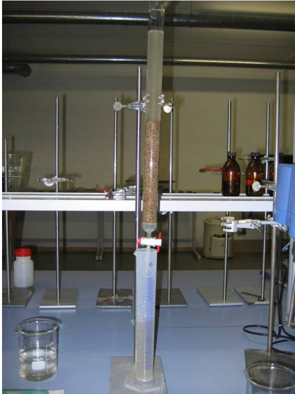
Fig. 36: Opstelling zandfilter in labo.
