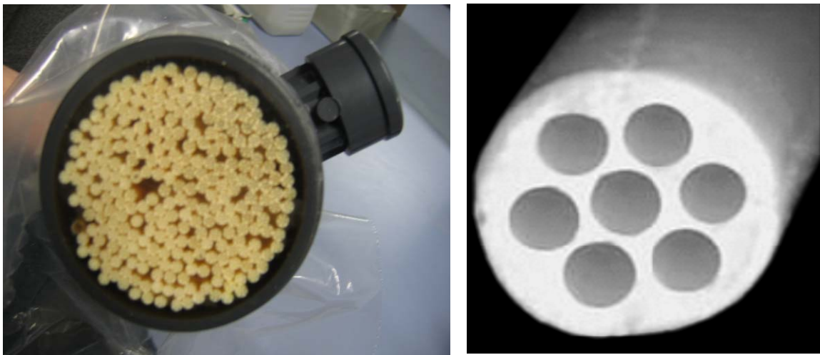
Fig. 28: De linkse figuur geeft de doorsnede van het INGE AG membraan, de rechtse figuur geeft één enkele vezel uitvergoot weer.
