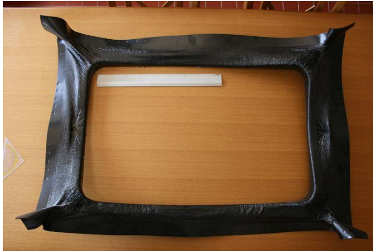
Figuur 18: Afvalmateriaal na X'Lite productiecyclus (de bijgeplaatste liniaal in de foto meet 40cm)
