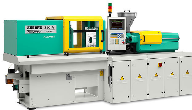
Figuur 25: Spuitgietmachine Arburg 320, type 50ton
