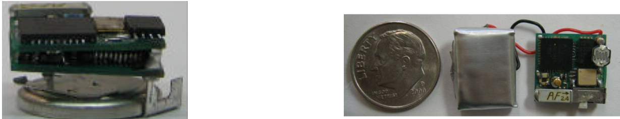
Figuur 4.2: Zendeel (links) en sensoreel (rechts) van de WSP
