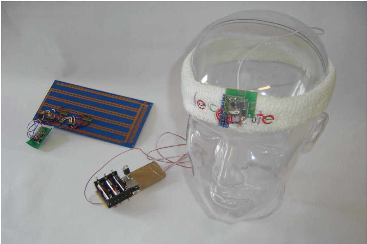
Figuur 5.1: Headbangsensor bevestigd op haarband.
