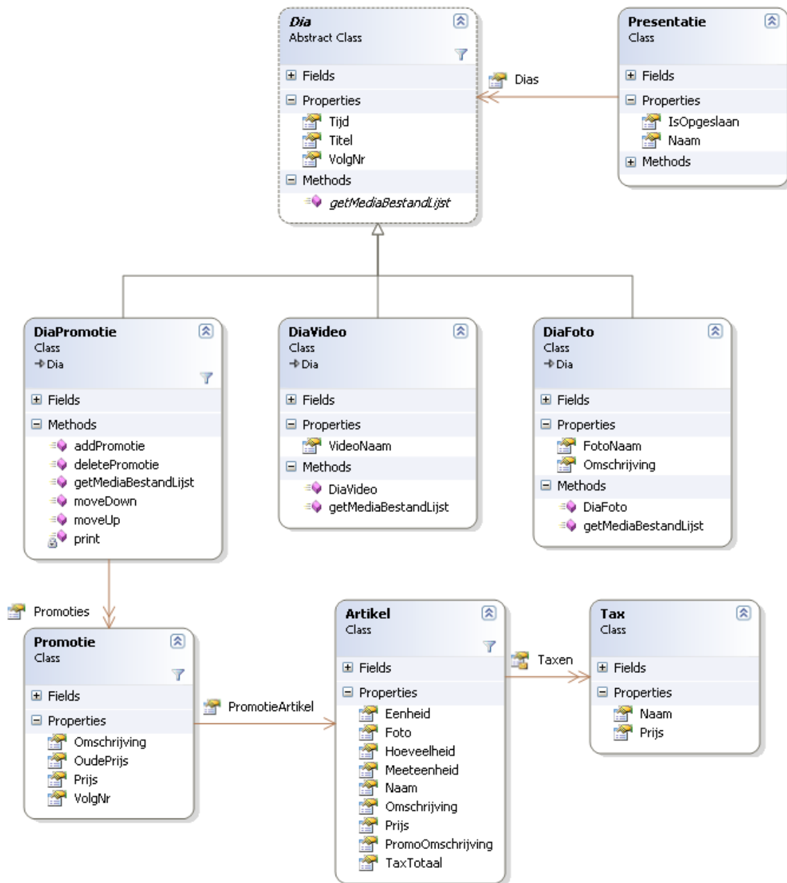
Figuur 21 Klassendiagram: Een presentatie is opgebouwd uit verschillende dia's
