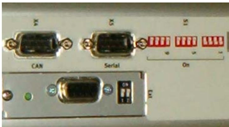
Figuur 6.20: Dipswitches voor Profibusadres
