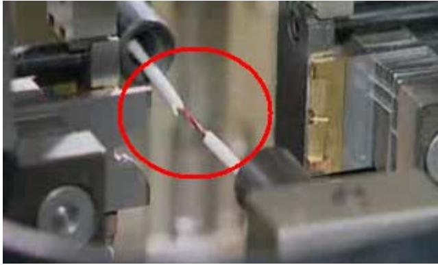
Figuur 2.23: Gedeeltelijk strippen van de draad [YOU]
