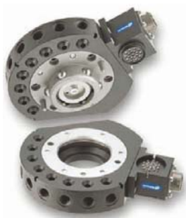
Figuur 2.15: Gereedschapswisselsysteem [SCHU]
