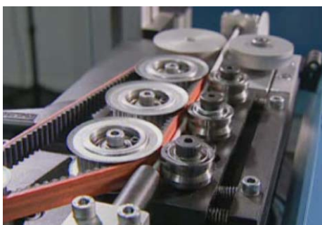
Figuur 3.3: Draadvoedingssysteem Wago [YOU]
