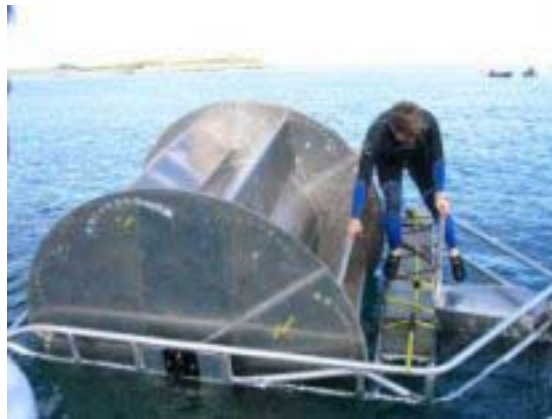
Figuur 5-14 : De HydroGen turbine met peddel [113]
