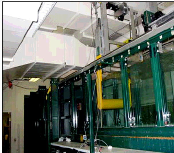
Figuur D-23 : VIVACE opstelling in de testtank van de Universiteit van Michigan [48]
