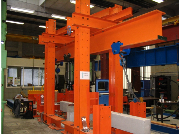
Figuur 1: Proefopstelling vierpuntsbuigproef
