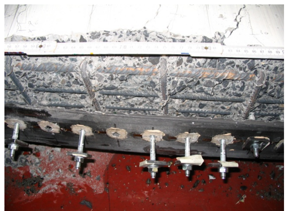
Figuur 168: Geen inscheuringen in de koolstofvezelwapening
