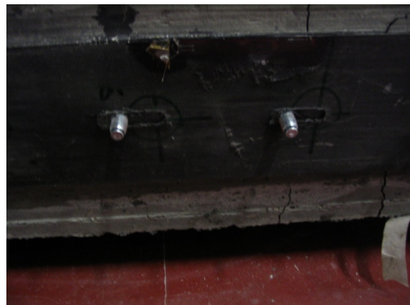
Figuur 105: Inscheuring M10 ankers
