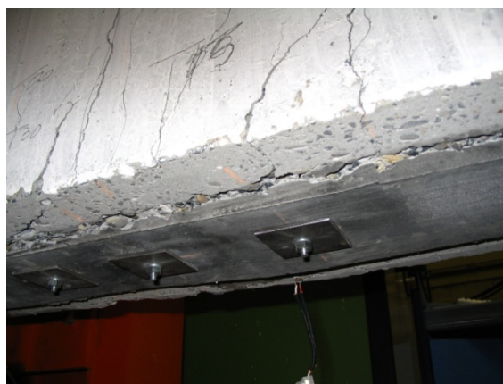
Figuur 43: Onthechting t.h.v. de linkerankers
