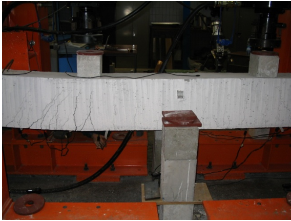
Figuur 179: Scheurvorming balk BLA2.10
