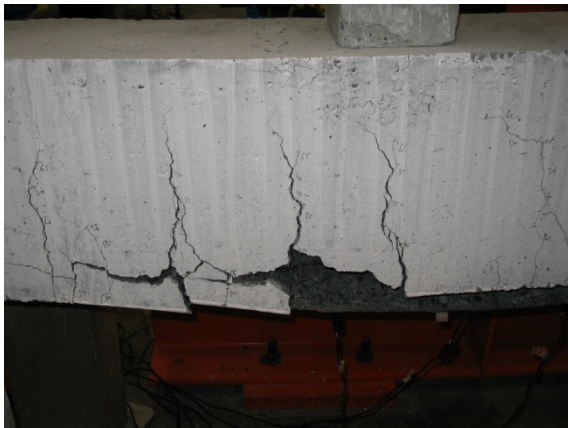
Figuur 189: Onthechting t.h.v. een verzwakte laag [1]
