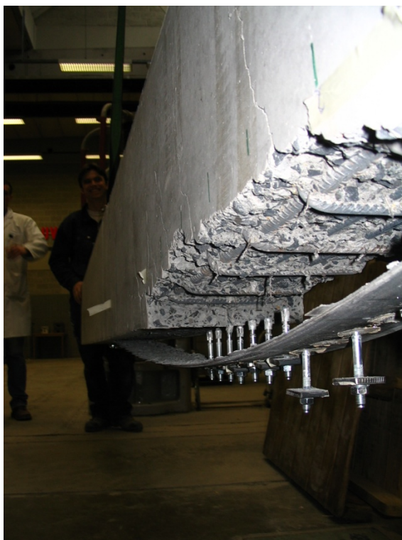
Figuur 169: Onthechting t.h.v. een verzwakte laag
