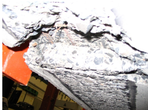
Figuur 97: Aanzet tot concrete rip-off [2]
