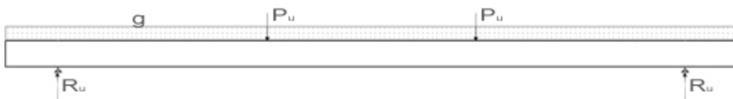
Figuur 82: Bepaling van de vijklkracht in de bezwijktoestand
