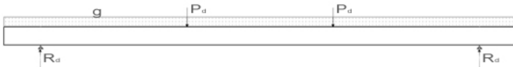
Figuur 80: Bepaling van de vjzjelkracht in de uiterste grenstoestand
