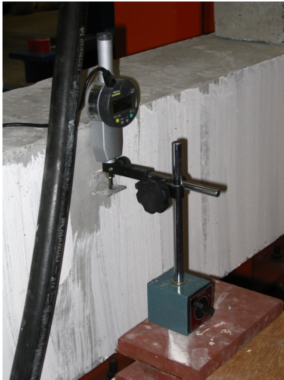
Figuur 4: Elektronische meetklok in het midden van de overspanning
