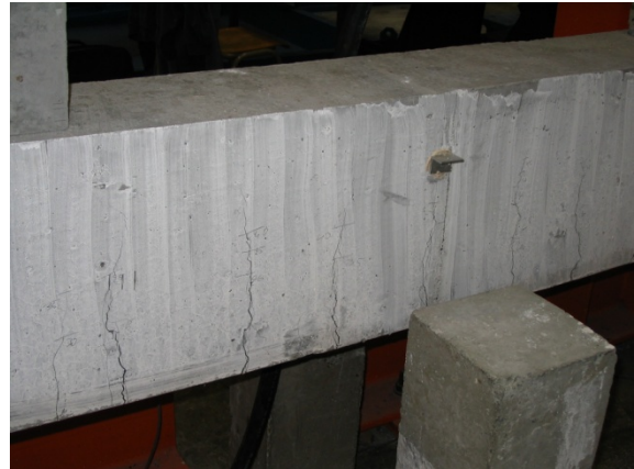
Figuur 91: Scheurvorming balk B2 [2]
