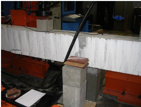
Figuur 163: Scheurvorming balk BLA2.8
