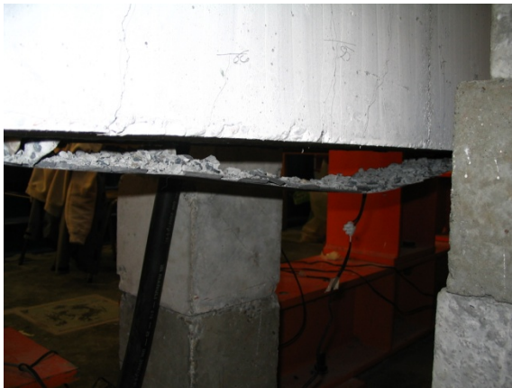
Figuur 62: Onthechting in het midden van de overspanning [1]
