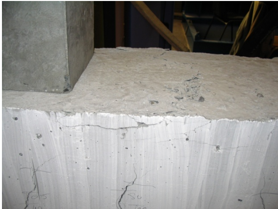
Figuur 50: Verbrijzeling van het beton
