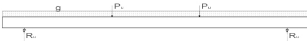
Figuur 71: Bepaling van de vijklkracht in de bezwijktoestand
