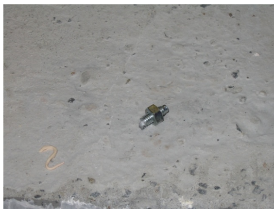
Figuur 41: Brosse breuk van een anker
