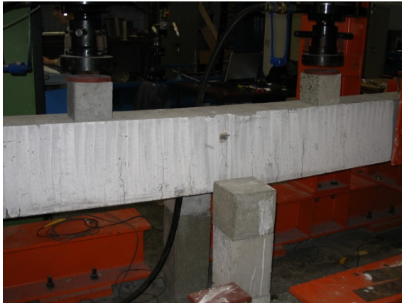
Figuur 90: Scheurvorming balk B2 [1]
