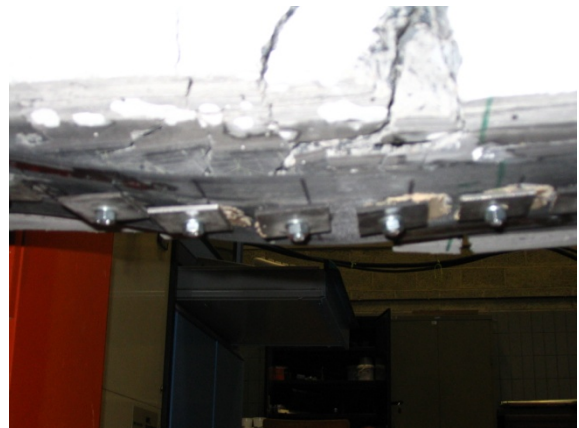
Figuur 149: Situatie ankers na de herbelasting
