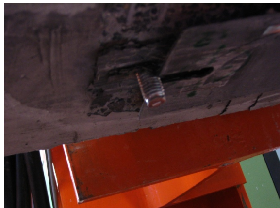
Figuur 113: Inscheuring M12 anker
