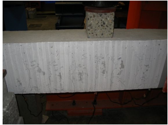
Figuur 61: Scheurvorming rechterkant balk BLA1.3
