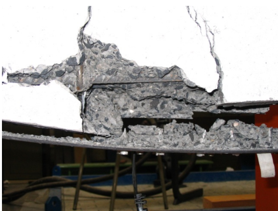
Figuur 191: Onthechting t.h.v. een verzwakte laag [2]
