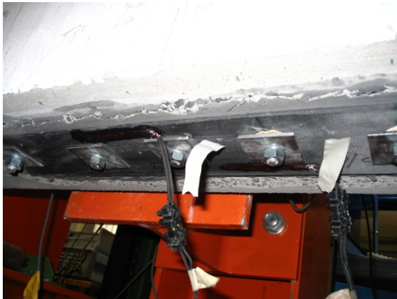
Figuur 156: Linkerankers na de eerste belastingsfase
