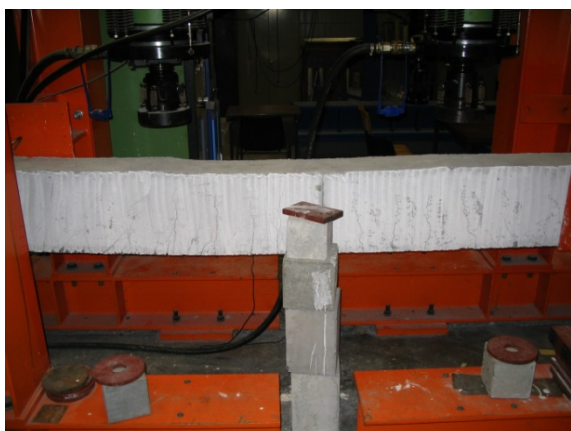
Figuur 40: Scheurvorming balk BLA1.1
