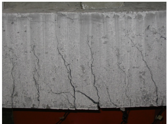
Figuur 209: Aanzet tot onthechting t.h.v. verzwakte laag
