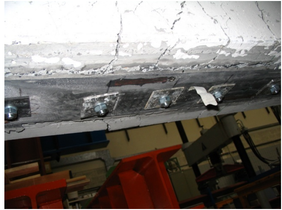
Figuur 173: Ankers worden niet uit het beton getrokken
