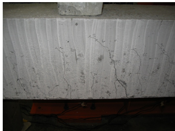
Figuur 119: Scheurvorming rechterkant balk BLA2.3
