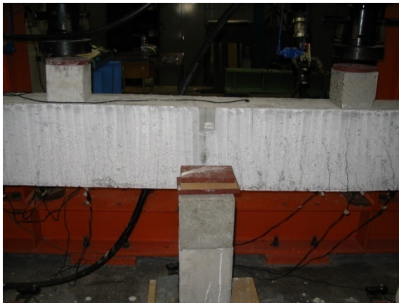
Figuur 206: Scheurvorming balk BLA2.13
