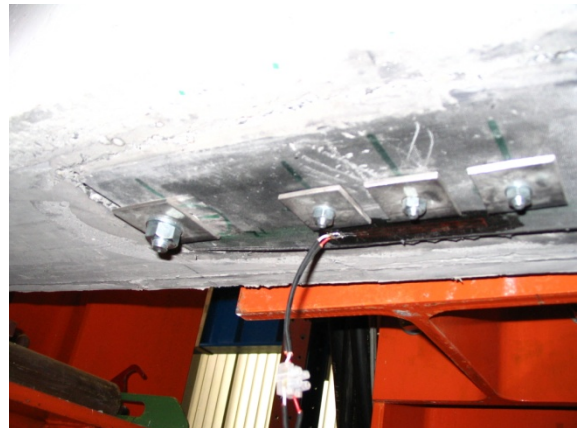
Figuur 138: Inscheuringen van de koolstofvezelwapening
