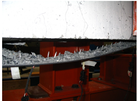
Figuur 190: Uitgetrokken ankers
