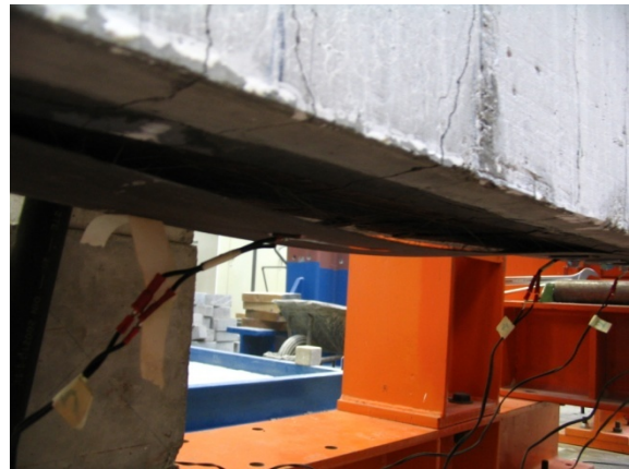
Figuur 103: Onthechting t.h.v. de koolstofvezelwapening [2]
