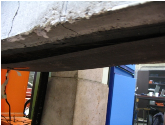
Figuur 102: Onthechting t.h.v. de koolstofvezelwapening [1]
