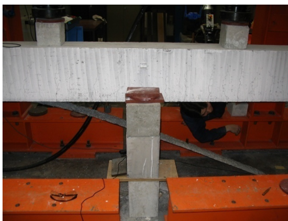
Figuur 216: Breukmechanisme van balk BL2.2
