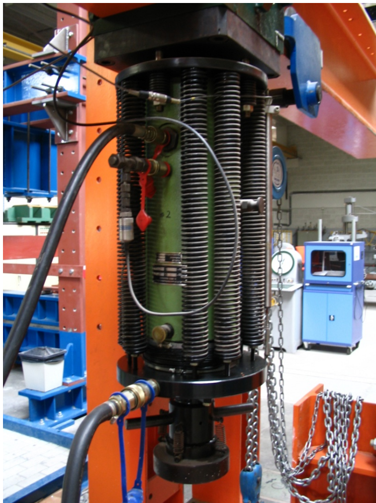
Figuur 2: Detail van een vijzel
