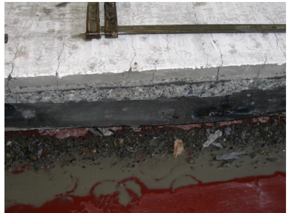
Figuur 63: Onthechting in het midden van de overspanning [2]
