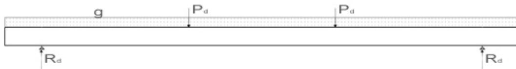
Figuur 22: Bepaling van de vijzelkracht in de uiterste grenstoestand
