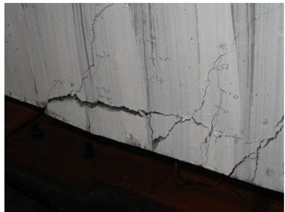
Figuur 166: Onthechting t.h.v. een verzwakte laag
