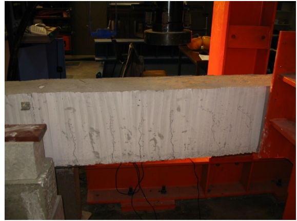
Figuur 49: Scheurvorming rechterkant balk BLA1.2
