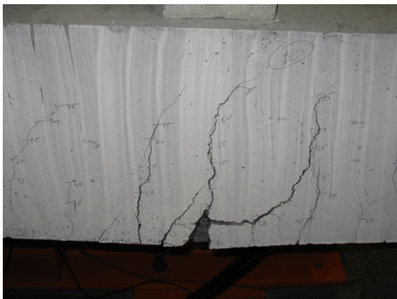
Figuur 148: Scheuren na de herbelasting
