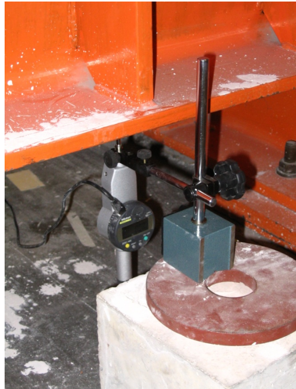
Figuur 5: Elektronische meetklok onder een steunpunt
