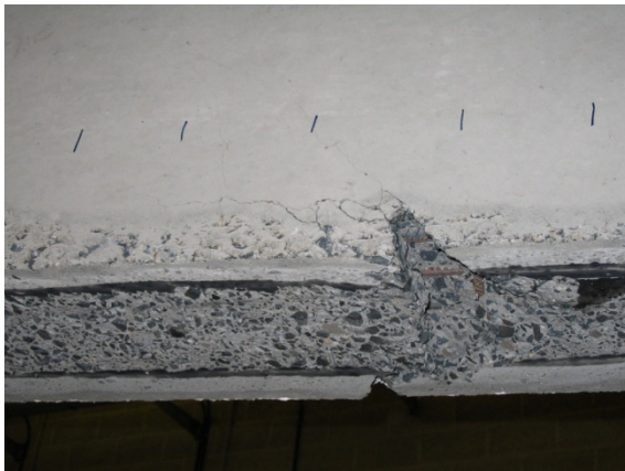
Figuur 96: Aanzet tot concrete rip-off [1]
