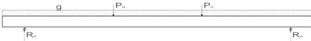
Figuur 14: Bepaling van de vijklkracht in de bezwijktoestand
