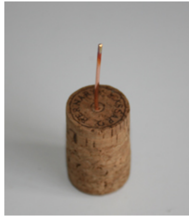
Het uiteinde van de koperen draad is rood geworden door Verhitting.
