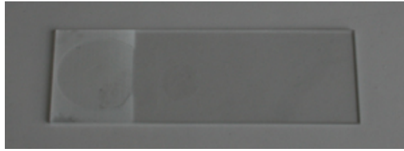
PVC Oplossing 1 wordt aangebracht.
