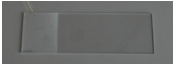
PVC Na verdamping van de ethanol uit oplossing 1, wordt het geconcentreerd zwavelzuur erop gedruppeld.
