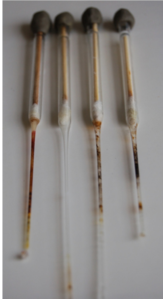
resultaat na 4 dimethylaminobenzaldetesten met PA. Het meest linkse resultaat benadert een positief resultaat.
