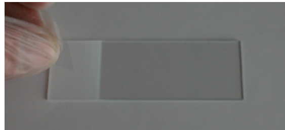
Wrijf zachtjes met de, te identificeren kunststof, over het mat glas.
