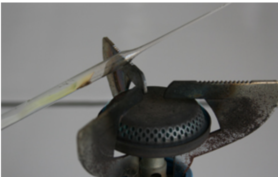
Het testpapier verkleurt wanneer er verbrandingsdampen beginnen vrij te komen.
