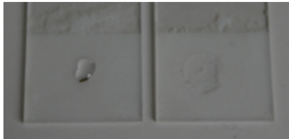
cellulosenitraat cellulose-acetaat Na verdamping van de ethanol uit oplossing 1, wordt het geconcentreerd zwavelzuur erop gedruppeld.
