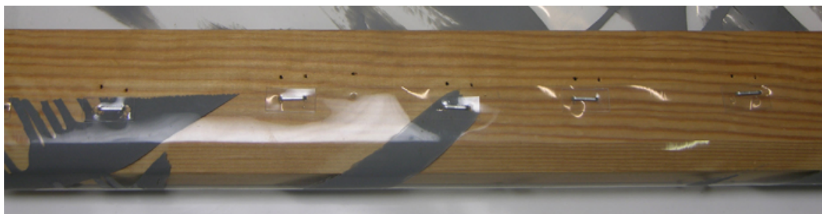
Het verschil tussen de oude inschietgaten en de nieuwe nietjes duidt op krimp door plasticizermigratie
