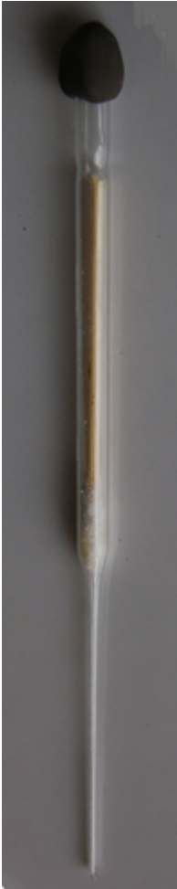
Pastuer pipet met PA in, reeds voorzien van de juiste reagentia.
