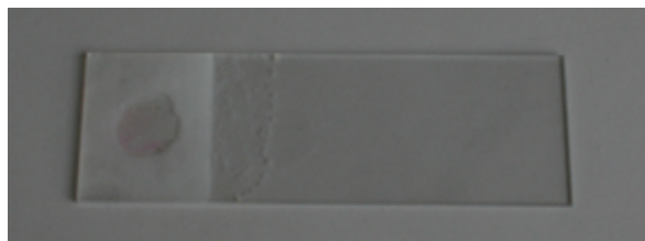
PVC Oplossing 1 wordt aangebracht.
