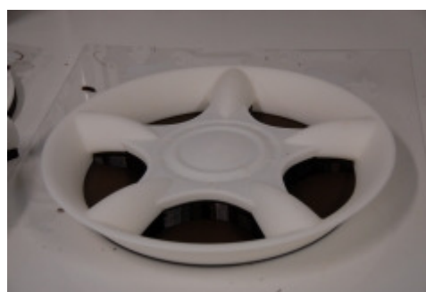
Figuur IV.19: Onderdeel gemaakt in ABS met FDM
