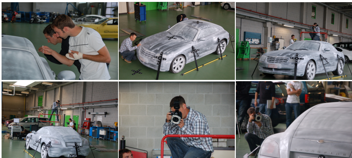
Figuur II.13: Proper maken van de meetpunten en foto's trekken van de Crossfire
