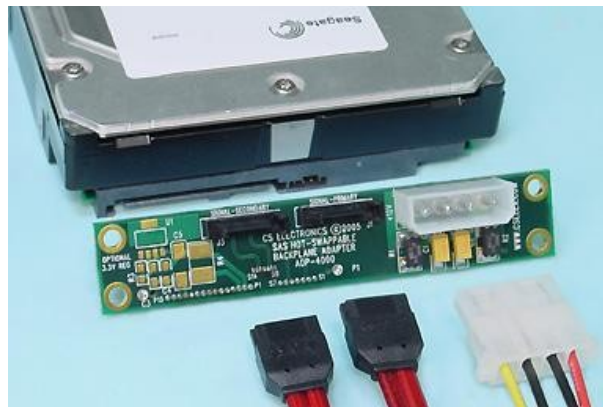
Figuur 2: Het is mogelijk 2 systemen een SAS loopwerk te laten gebruiken, in theorie is zelfs dubbele doorvoersnelheid mogelijk
