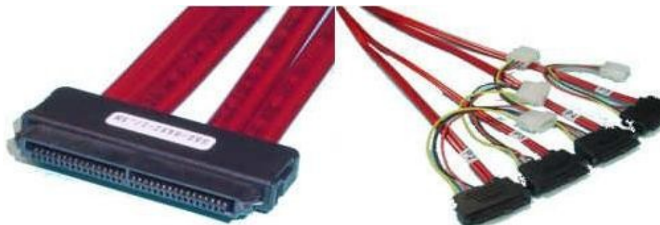
Figuur 103: SFF-8484 (backplane) naar SFF-8482 (apparaat)
