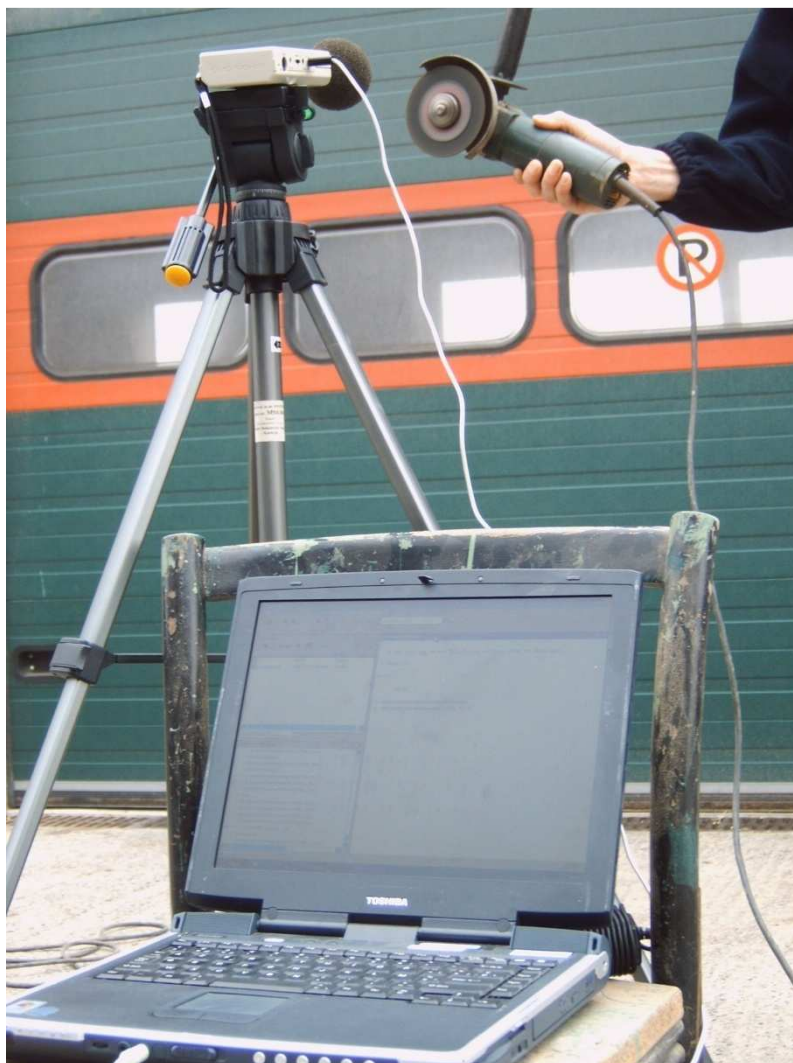
Figuur 6.4: Geluidspname van de onbelast draaiende kleine slijpmachine
