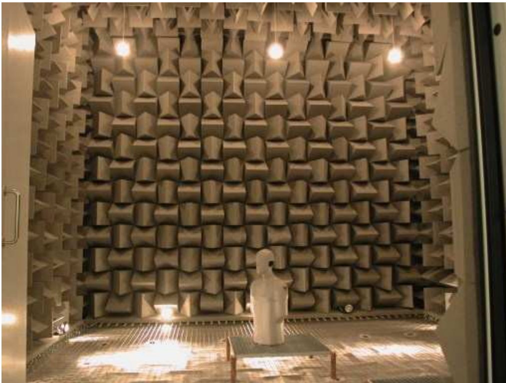
Figuur 4.2: Een artificieel hoofd en torso geplaatst in een anechoïsche kamer.
