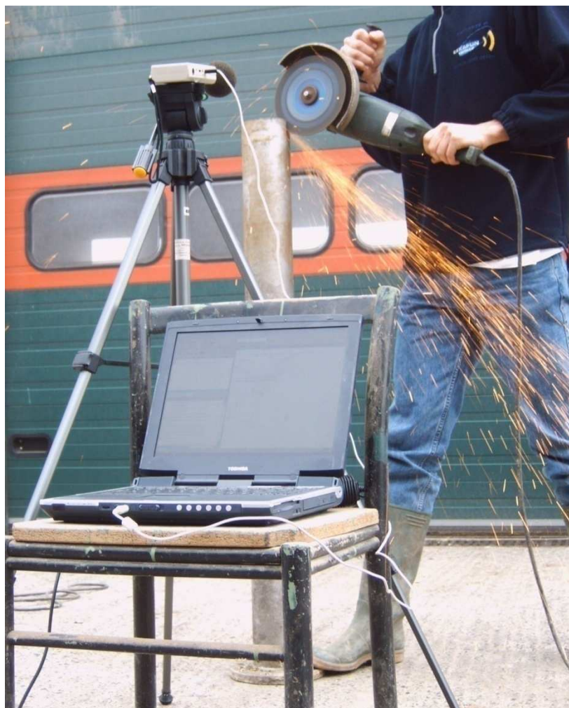
Figuur 6.5: Geluidscaptatie van de grote slijpmachine in gebruik.
