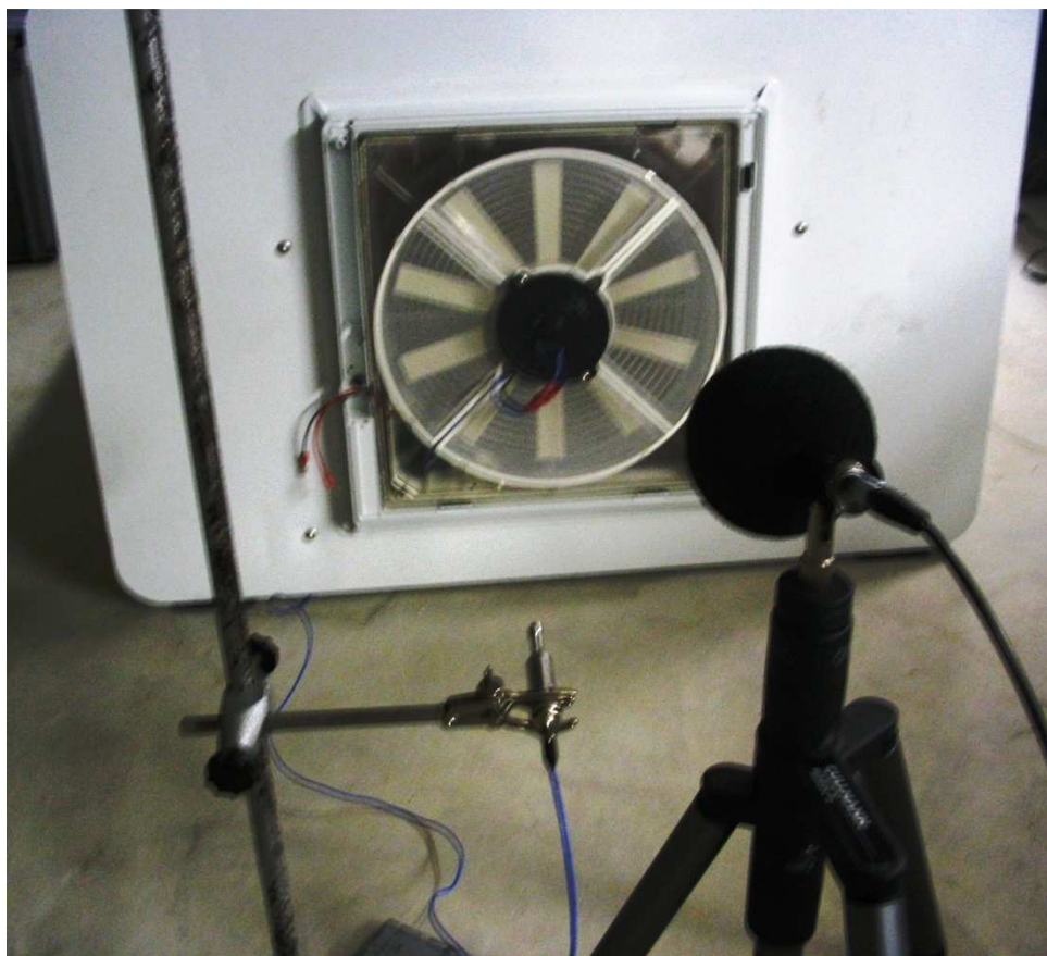
Figuur 6.14: De testopstelling met de tien schoepen tellende ventilator.
