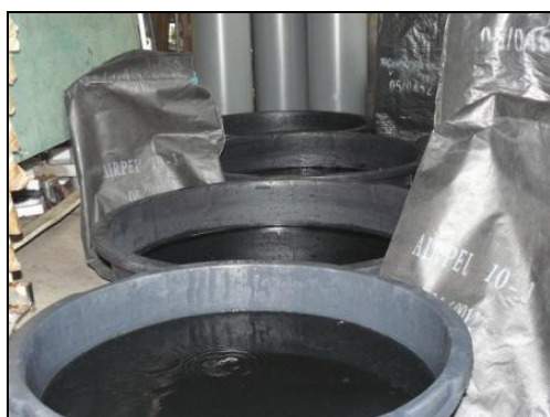
Figuur 6.14.: bevochtiging van de AK in kuipen Figuur 6.15.: ontsnappende lucht uit droge AK
