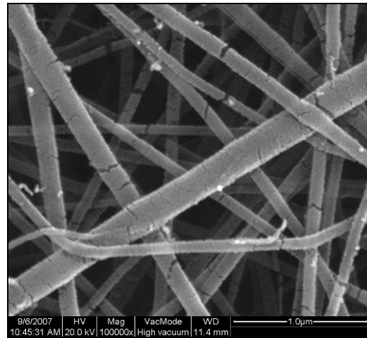
Figuur 7.23 en Figuur 7.24.: Hoog vacuüm SEM beelden van nieuw nanovezelmembraan
