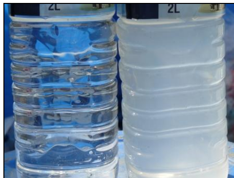
Figuur 7.14.: visueel waarneembare kwaliteitsverbetering na membraanfiltratie
