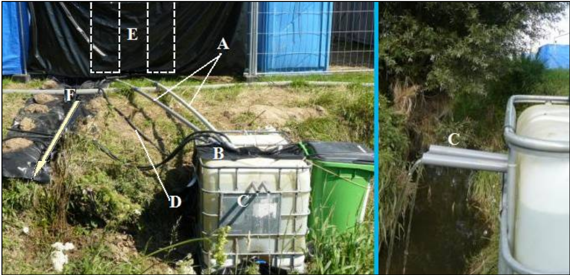
Figuur 6.10.: het buffervat als onderdeel van de pilootopstelling (Dranouter festival '07)
