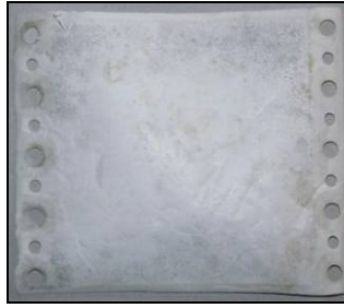
Figuur 6.4.: membraan met afwisselend grote en kleine perforaties
