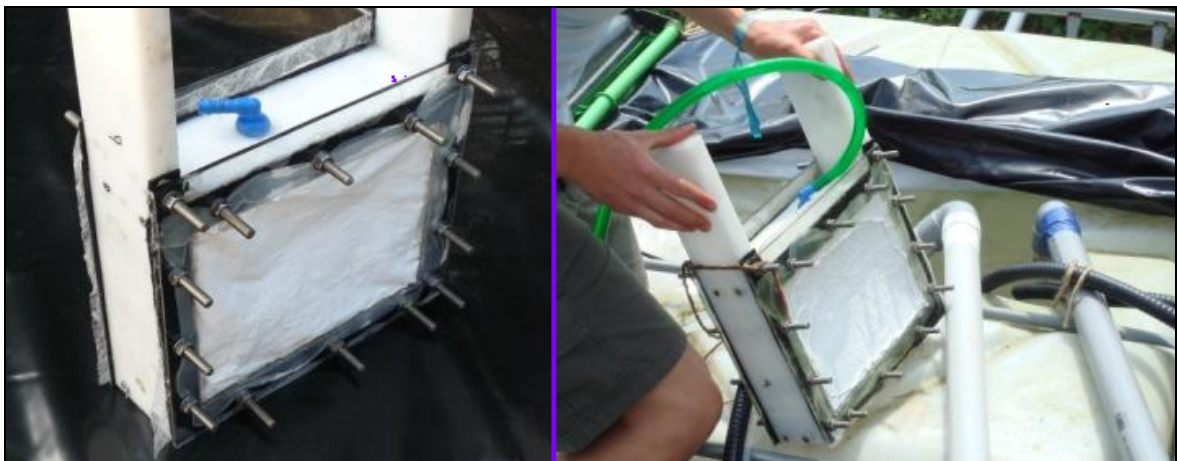
Figuur 6.18.: membraanopstelling toegepast op het festival: module en pomp
