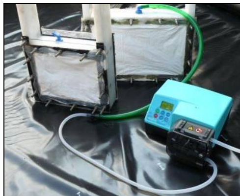
Figuur 6.18.: membraanopstelling toegepast op het festival: module en pomp
