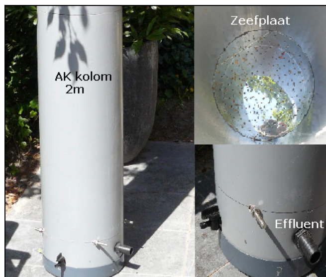
Figuur 6.12.: De AK kolom met zeefplaat
