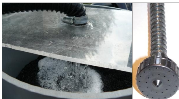
Figuur 6.13.: links: kolom in werking, rechts: sproeikop met aanvoerleiding
