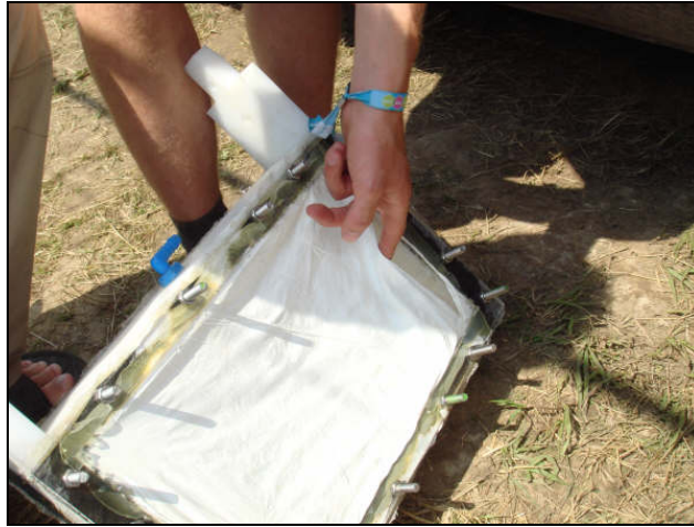
Figuur 8.1.: het vernietigende effect van backflushing op een membraanmodule
