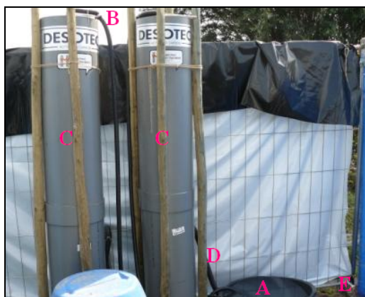
Figuur 6.16.: de AK eenheid als onderdeel van de pilootopstelling (Dranouter festival '07)
