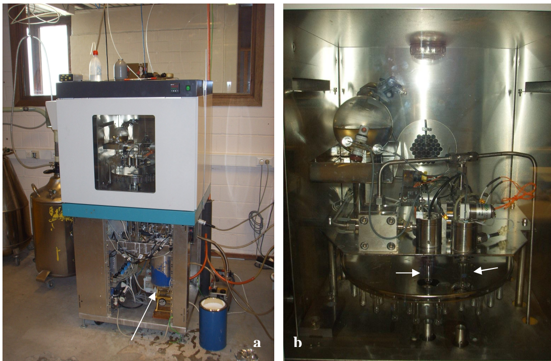
Figuur 8.1: a) de ThermoFinnigan Kiel III in het Stabiele Isotopenlab van de VUB met links de vaten voor toevoer van vloeibare stikstof. Het gesloten gedeelte is de oven, daaronder bevindt zich het vat voor het fractioneel vriezen van het gevangen gas (pijl) b) detailopname van de oven met linksboven het zuurvat en onder de carrousel met de staalhouders. De pijlen duiden geconnecteerde staalhouders aan.
