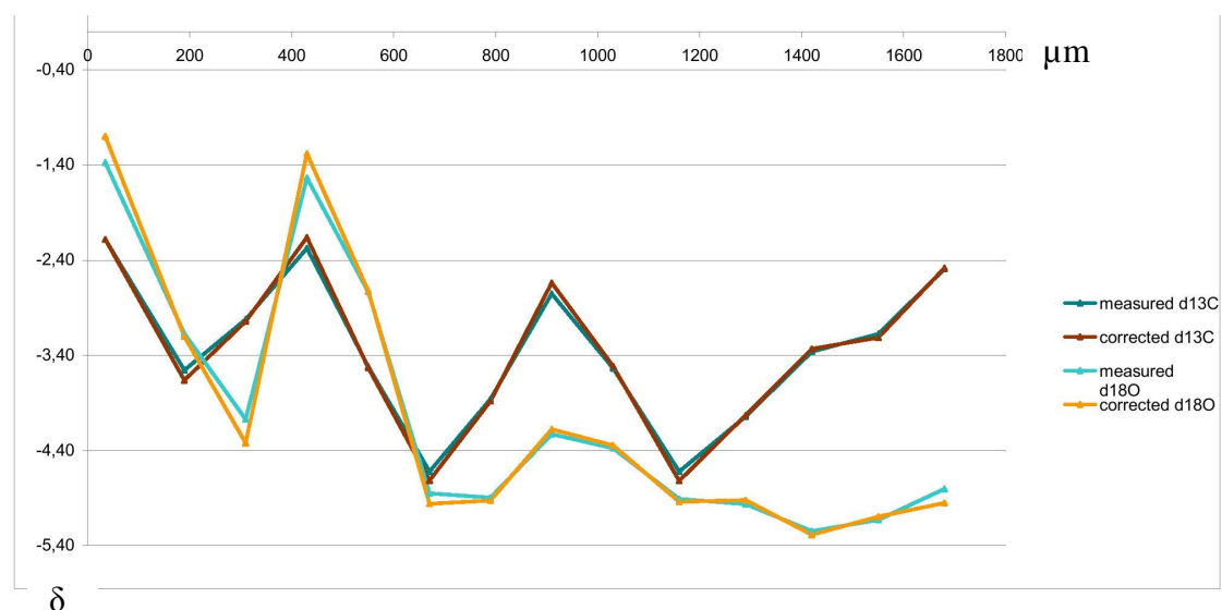
Figuur 13.2: correctie voor uitmiding bij het boren van de seizoenale datareeks van otoliet O3A ( Paraconger papointi , Zanden van Egem).
