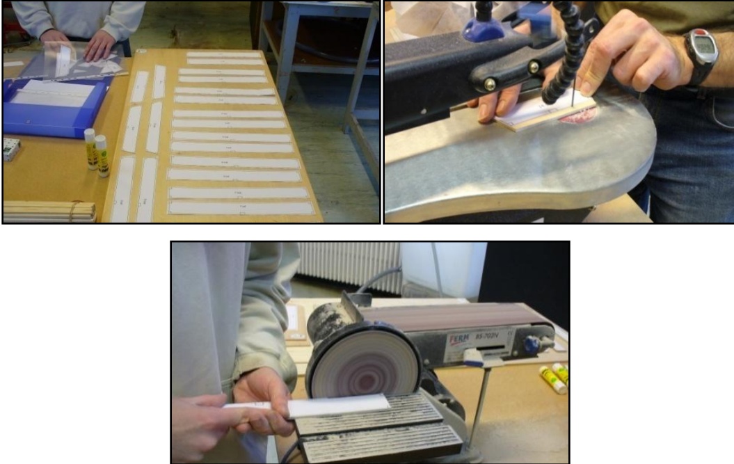
Foto's 17, 18 en 19 - Het opplakken van de spantvormen op de triplex plank. Het fijn zagen en fijn schuren van een spant.
