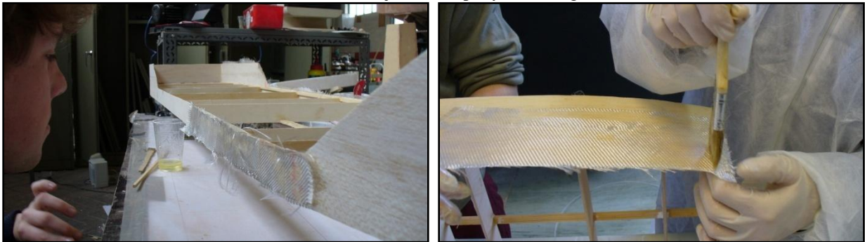
Foto's 35 en 36 - Absorptie van het epoxy door de vezels. Het verdrijven van de luchtballen.
