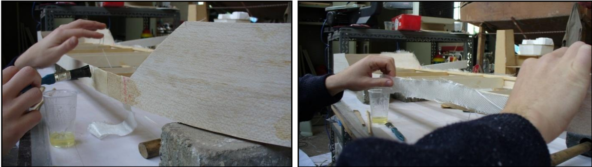
Foto's 33 en 34 - Het bestrijken met epoxy. Plaatsing van de vezels.
