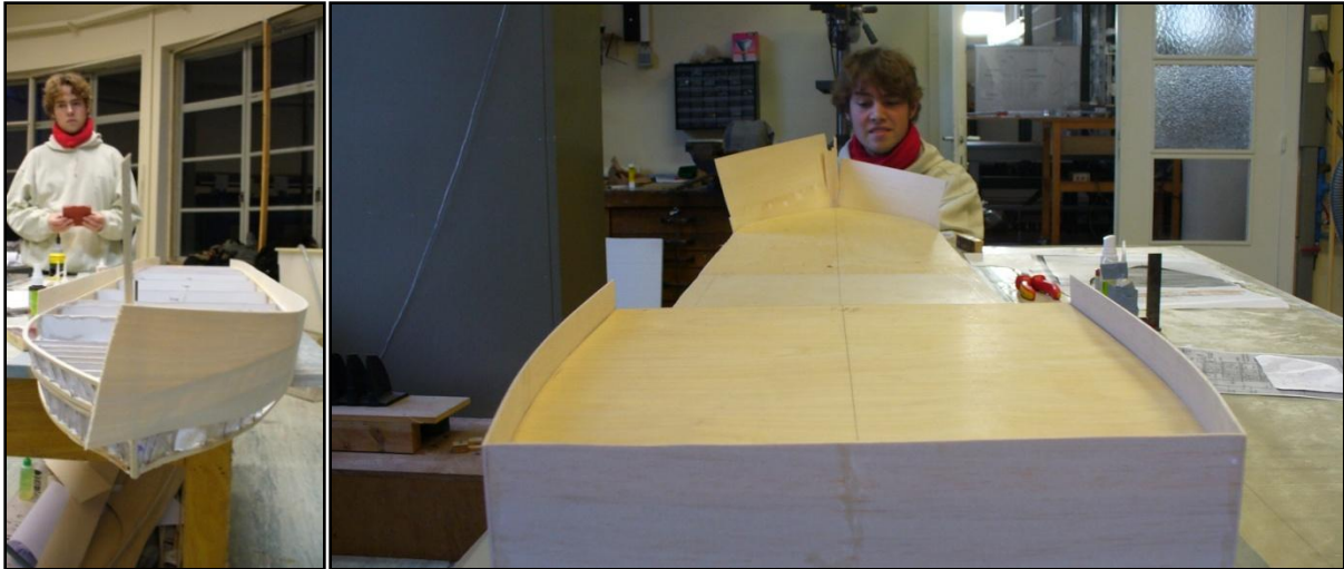
Foto's 28 en 29 - Het verlijmen van de rompbeplating op de steunlatten.
