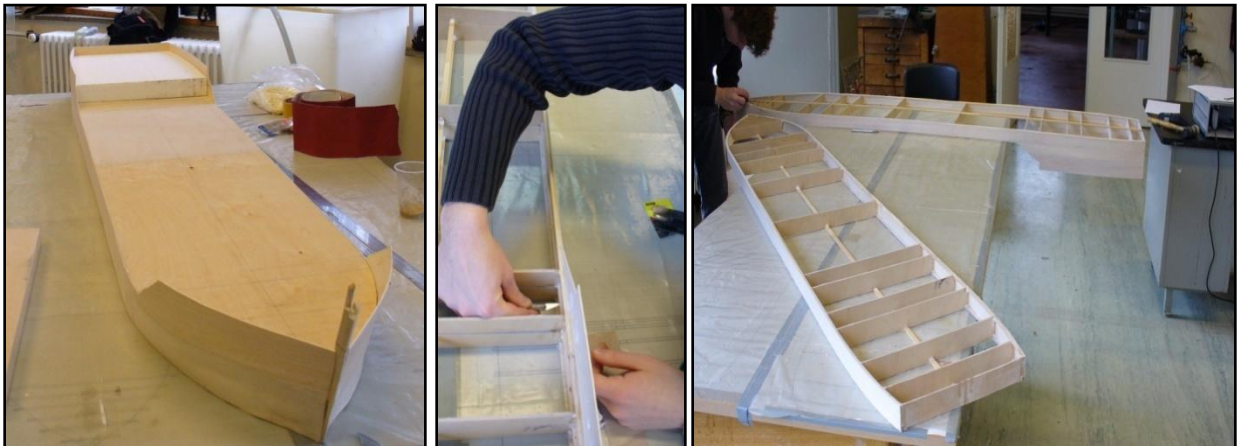
Foto's 30, 31 en 32 - Einde van de plaatsing van de beplating. Het snijden van de romp in twee delen. De twee delen van de romp.
