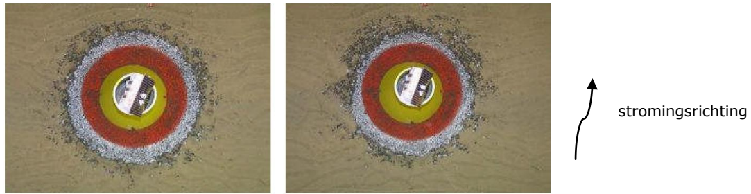
figuur 68 Resultaten van test 10: GBF vóór en na de test [19]
