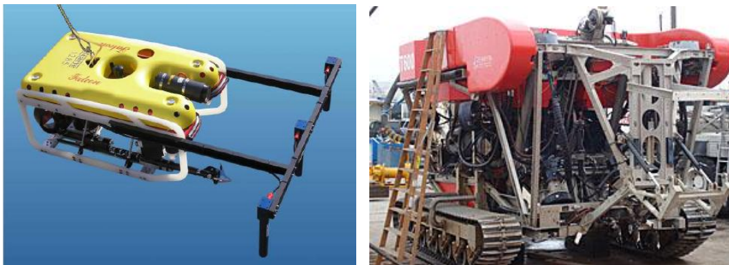
figuur 118 Gespecialiseerde ROV gebruikt bij het opsporen van de gemagnetiseerde kabels en Trenching ROV gebruikt bij het corrigeren van de kabeldieptes [33], [91]
