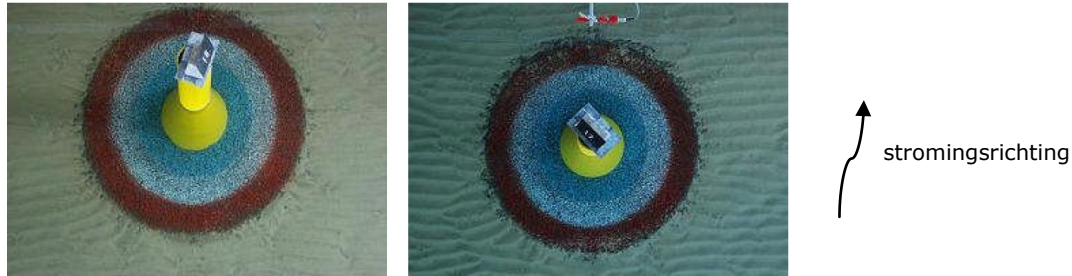
figuur 70 Resultaten van test 2: GBF vóór en na de test [19]
