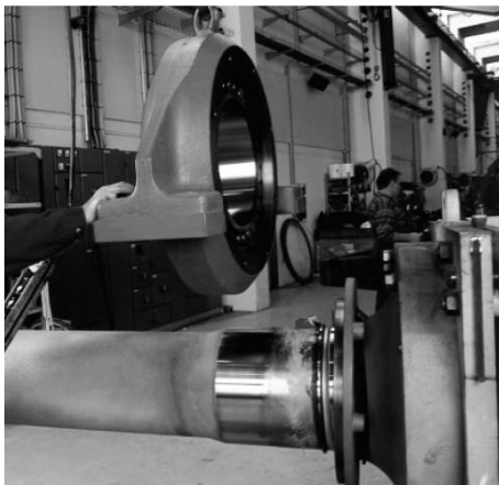
figuur 29 Turbine-as en eerste lager tijdens constructie [3]
