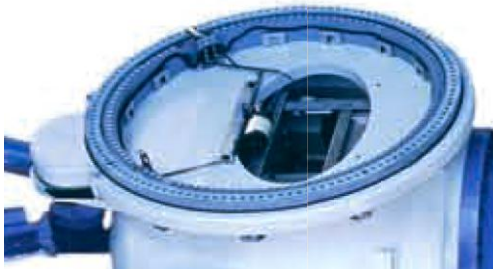
figuur 122 Detail van figuur 121: aan de binnenkant van de cirkelvormige uitsparing is het tandwielprofiel voor het draaien van de bladen met behulp van het pitch-systeem zichtbaar [47]
