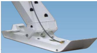
figuur 111 Detail van een skid, gebruikt om de ploeg omhoog en omlaag te tillen [38]
