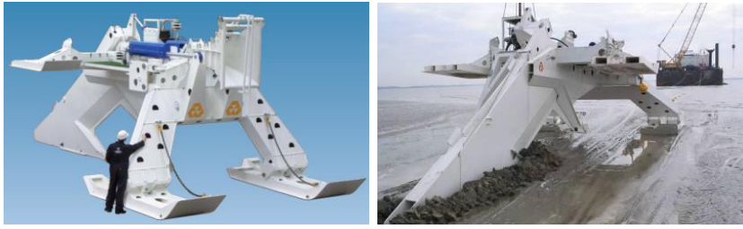
figuur 110 De zeeploeg, gebruikt bij het ingraven van de energiekabels [30]
