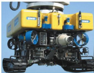
figuur 114 'Atlas 2' ROV met afmetingen 3,8m op 3,8m en 2,5m hoogte [41]
