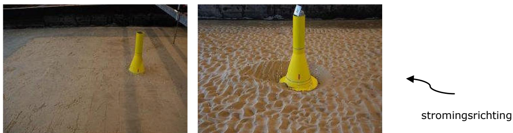
figuur 67 Resultaten van test 12: GBF vóór en na de test [19]
