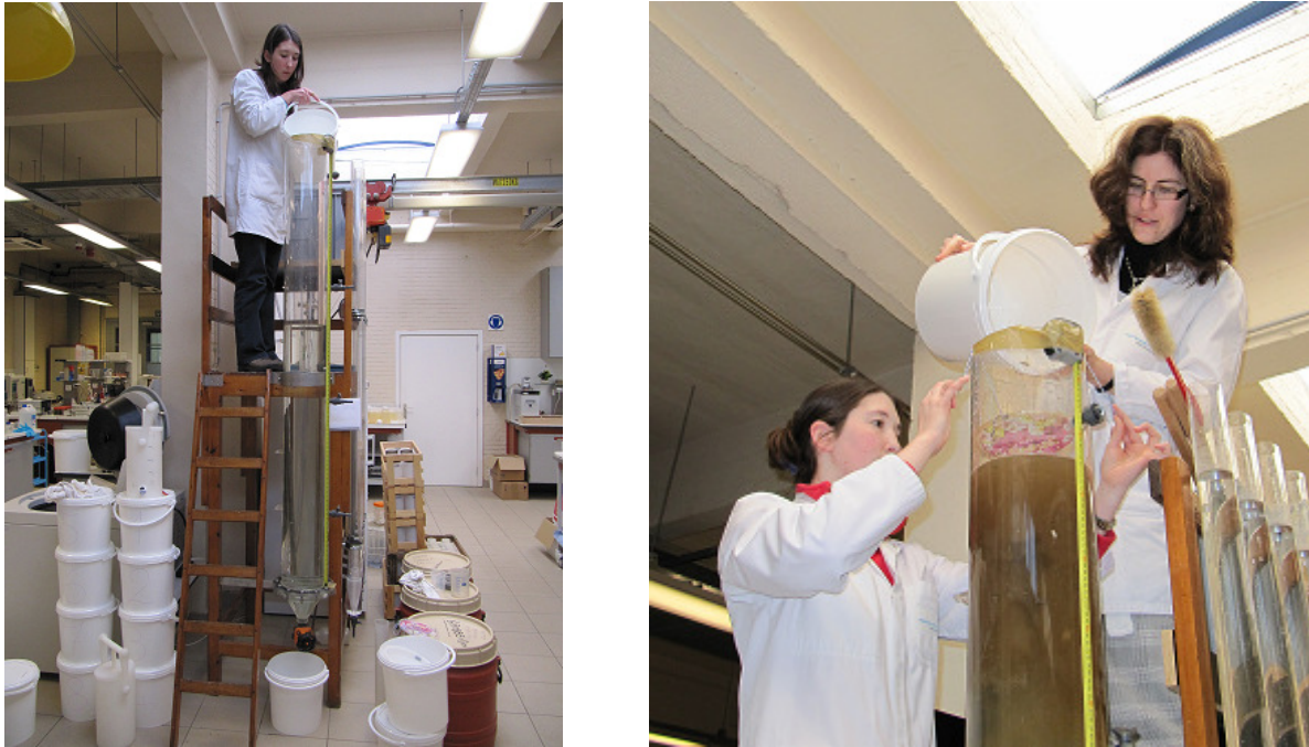
Figuur 13: Het vullen van de bezinkingsbuis met sedimentloos rivierwater (links) en het toevoegen van de sedimentconcentratie (rechts)
