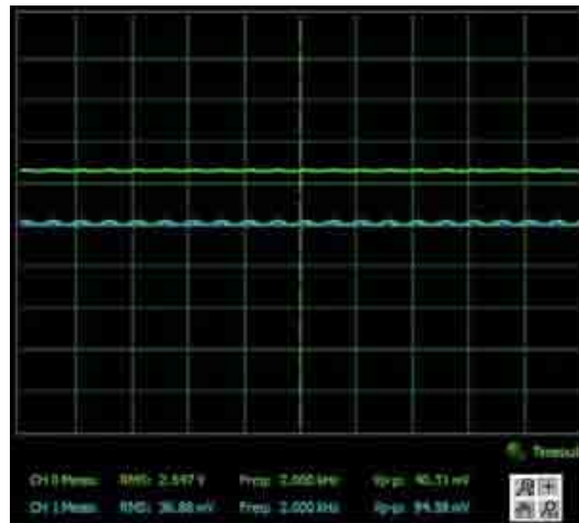
Figuur 3.39 – Uit te lezen signalen in een lock situatie, f_{sig} = 1\text{kHz} en f_{ref} = 1\text{kHz} .
