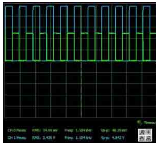
Figuur 5.6 – Ingangssignaal aan de buffer en referentie signaal van de AD630 voor de I detectie.
