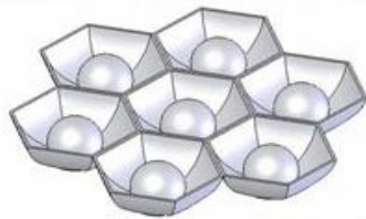
Figuur 1.4: Bolvormige zonnecel
