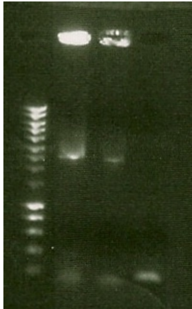
FIGUUR III-3: KOLONIE PCR UITGEVOERD MET PRO-2600 EN PRO-2601 OP MUTANTE KOLONIES. In de eerste laan is de SmartLadder te zien. In de tweede en derde laan zijn rfaG mutanten te zien. Er is maar één bandje op te merken, dat zoals verwacht iets hoger dan 2,5 kb ligt. Onderaan in laan 2, 3 en 4 zijn primerdimeren te zien. In de vierde laan is genomisch DNA te zien ter controle, zoals verwacht annealen de primers hier niet.
