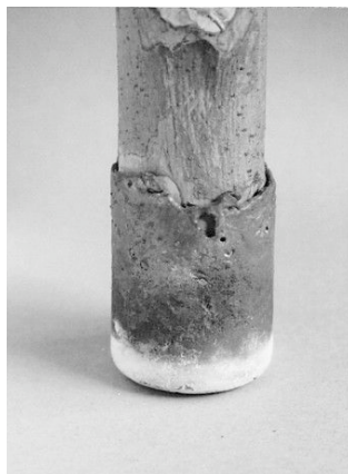
Figuur 31. Buisje in koperblad na experimenteel gebruik als boor. (Stocks (2003). Experiments in Egyptian archaeology , fig. 5.18.)
