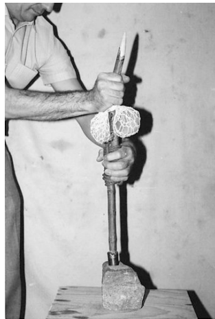
Figuur 30. Experiment met steenboor met buisje in koperblad als boor. (Stocks (2003). Experiments in Egyptian archaeology , fig. 5.16.)
