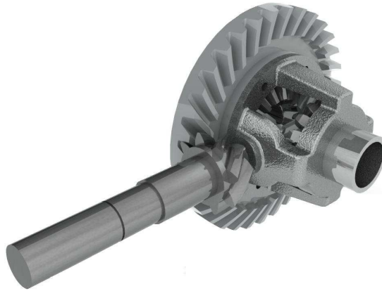
Figuur 2. Rondselas en differentieel als reductie
