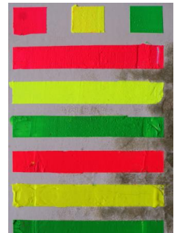
Figuur 44: beschimmelde testplank
