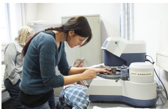
Figuur 32: foto: monsters worden in de polijstmachine geplaatst
