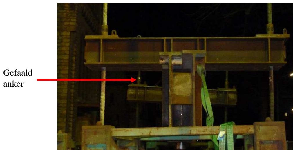
Figuur 8.19 Scheefstand van de profielen na het falen van het anker
