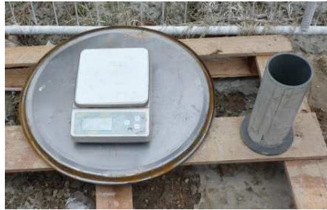
Figuur 8.12 Controle van de dichtheid van het groutmengsel
