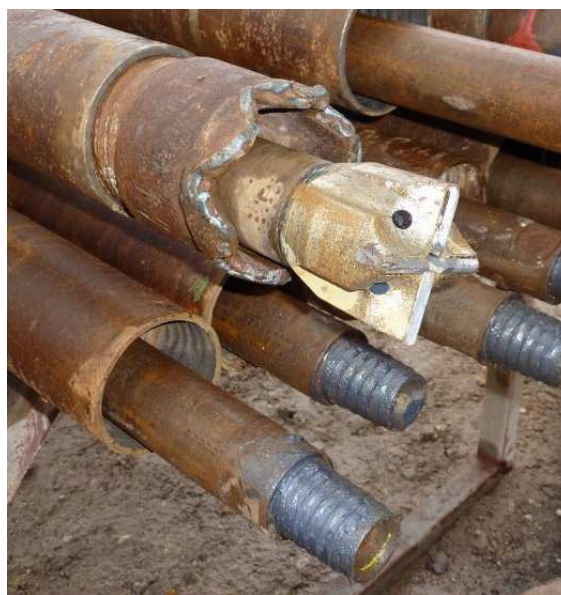
Figuur 8.4 Buiten- en binnenstangen waarvan de eerste is voorzien van een boorkop
