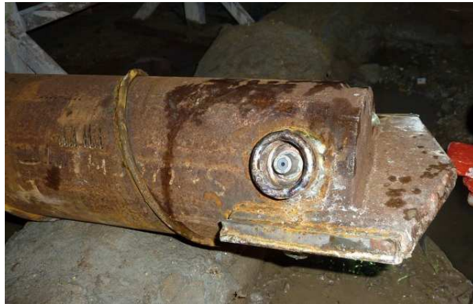
Figuur 8.9 Snijschoen en spuitkop van de VHP-LR
