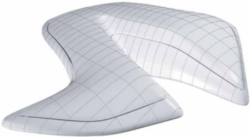
091 - Digitaal model in rhinoceros met de zichtbare afwateringsvoeg
