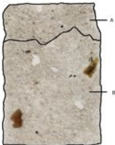
Fig. 15: Scan van slijpplaatje M81 met de aanduiding van de verschillende stratigrafische eenheden.
