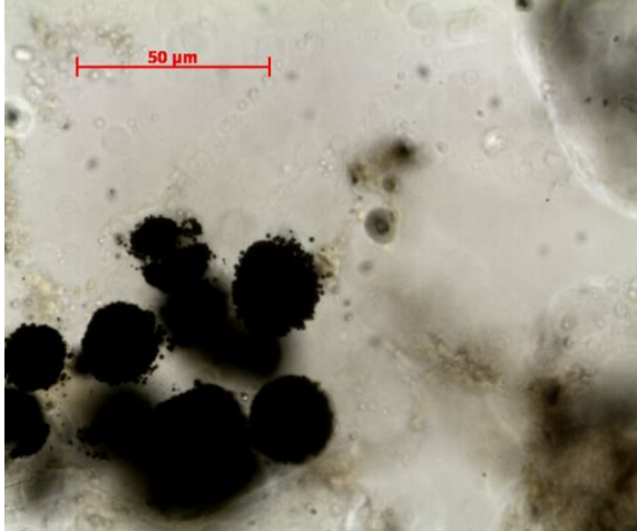
Fig. XVII: M79, A, PPL, x400. Detail van pyriet. Pyriet is soms moeilijk te onderscheiden van andere donkere elementen. Bij een hogere vergroting valt het op dat pyriet opgebouwd is uit kleine rond kristalletjes die op hun beurt bestaan uit zeer kleine bolletjes.
