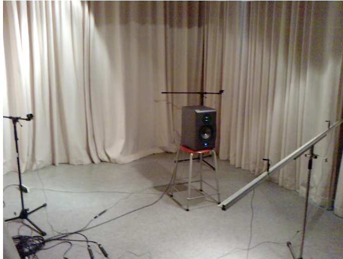
FIGUUR 5.1: Foto van het labo, met de opstelling van bron en microfoons.
