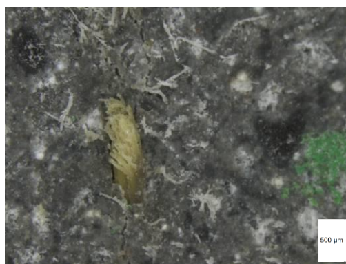
Figuur 96: Baststengels van vlas als scheurinitiatoren
