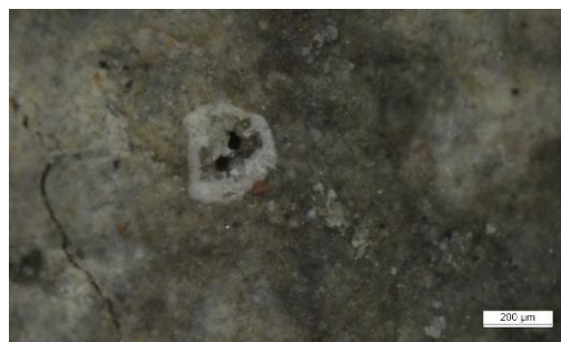
Figuur 161: Koepelvorming na desorptie van een SAP B partikel (2 m%)
