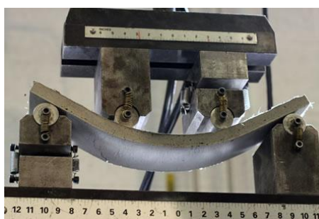
Figuur 7: Voorbeeld van de ductiliteit van ECC [30]
