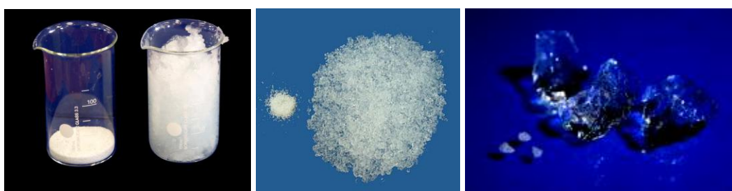
Figuur 35: Impressie van absorptie bij SAP [78]
