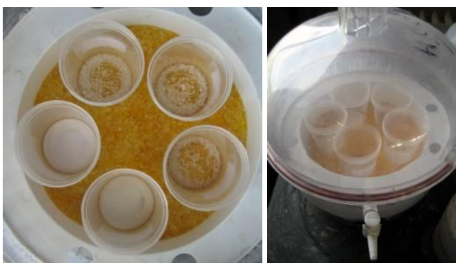
Figuur 52: Vacuüm drogen van SAP met silica-korrels
