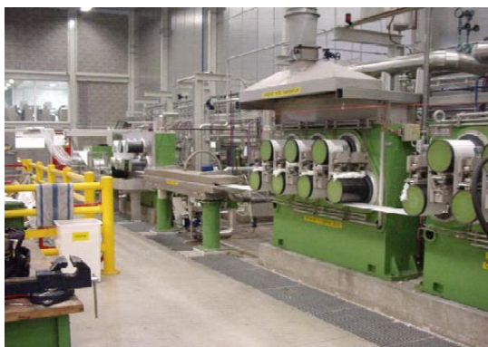
Figuur 6: Spinopstelling te Redco voor de productie van PP-vezels [18]
