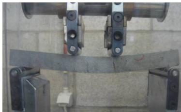
Figuur 125: 6 mm doorbuiging bij voorbelasting van een PPm 2 proefstuk
