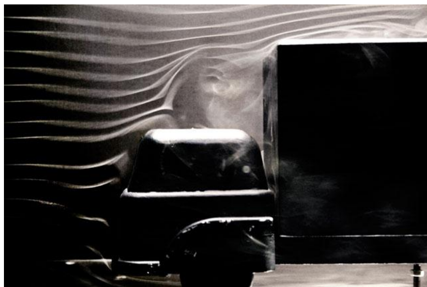
Figuur 54 Rooktrajectoriën bij windtunnelproef [32]
