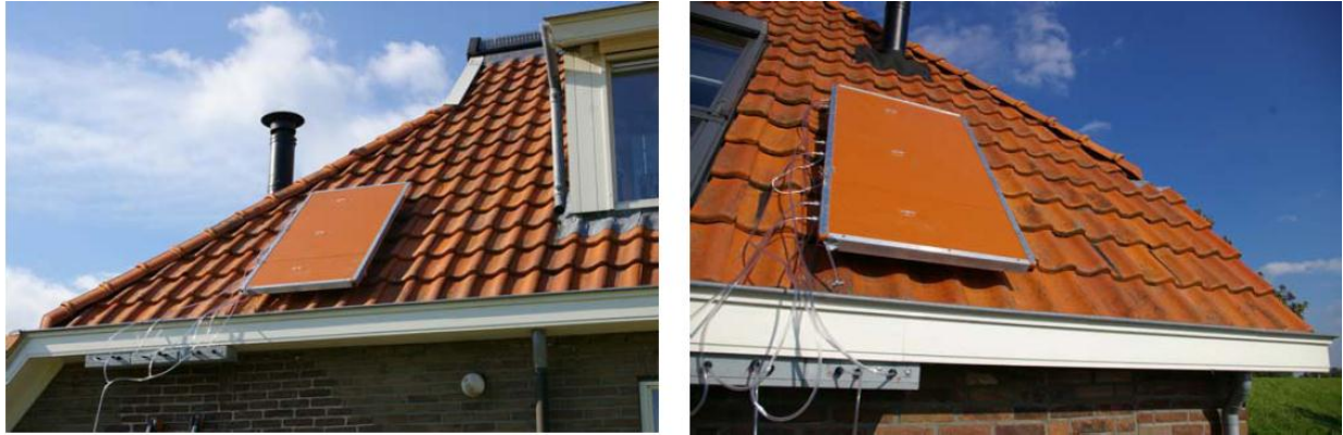
Figuur 53 Meetopstelling voor on-top module [31]
