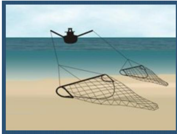
Figuur 8: Vissersvaartuig met dubbele boomkor (Vismethodes, z.j.)
