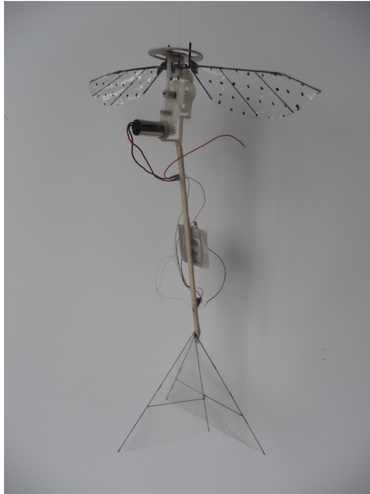
Figuur 4.9: Het microvliegtuig met flappende vleugels met een vleugelspanwijdte van 113 mm en een gewicht van 4,15g.
