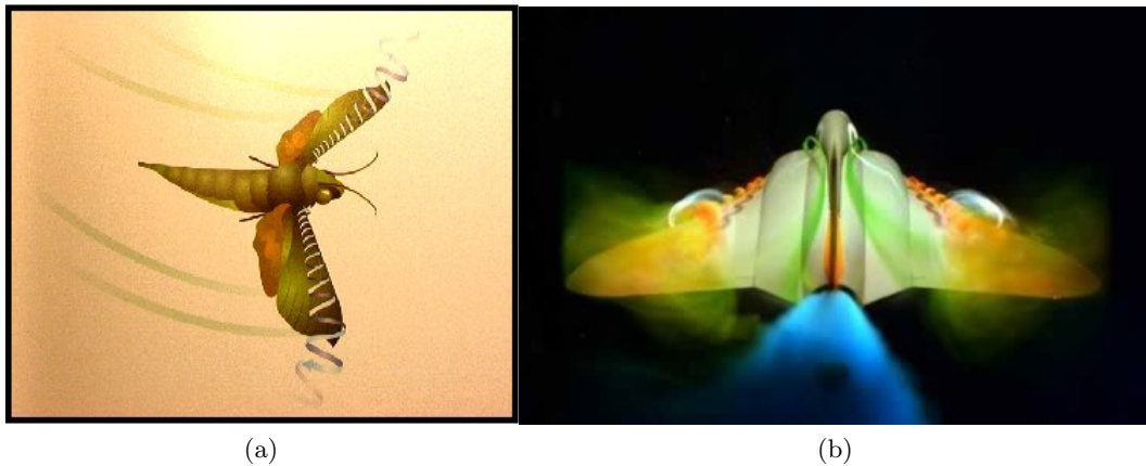
Figuur 2.3: Zowel bij flappende vleugels (links [27]) als bij deltavleugels (rechts [3]) wervelt de aanvalsboordwervel onder invloed van een spangewijze stroming als een groeiende spiraal over de vleugel richting vleugeltip.
