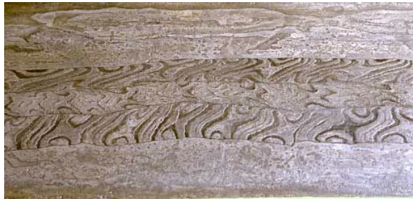
Afb. 9: Detail van een 'yataghan' met typisch getorst damast, ook wel 'Turks' damast genoemd [38].
