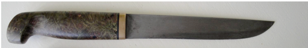
Afb. 38: Jachtmes met lemmet van gebroken kroezenstalen zwaard (Gotscha Lagidse)
