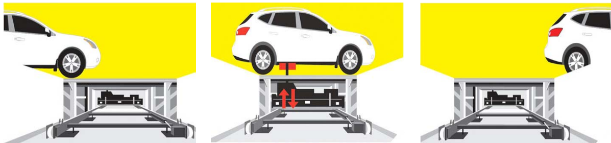
Figuur 10 - Werking batterijwisselstation
