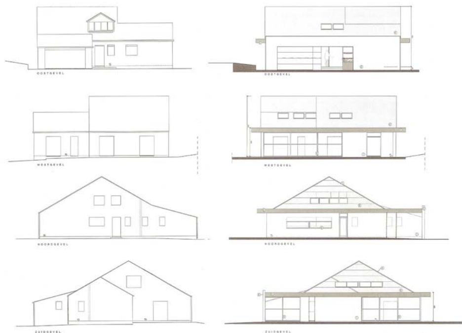
Afbeelding 5.4.4.26: De gevels voor en na de verbouwing
