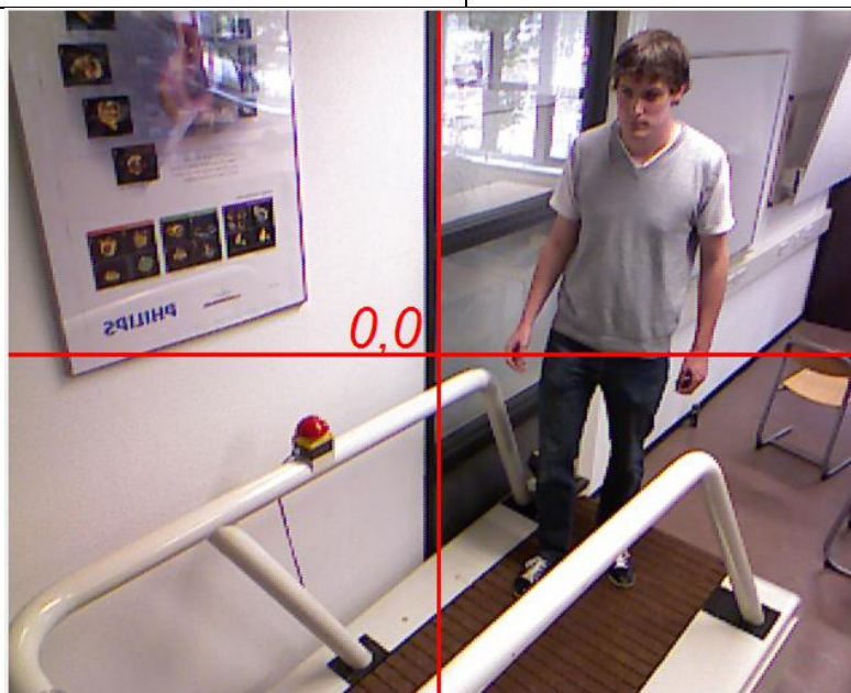
Figuur 35: opstelling loopband met 30° draaihoek
